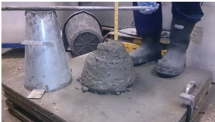
Figur 35. 12 cm synk, betongblanding D.
