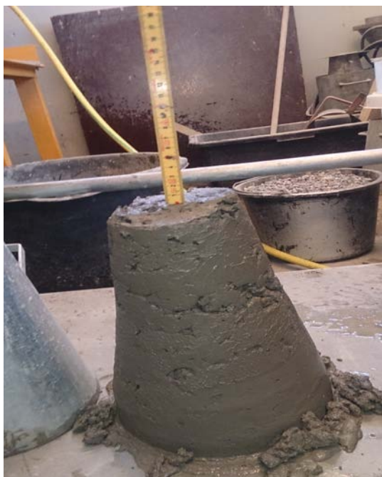
Figur 33. Synkprøve blanding B. 2 cm synk.
