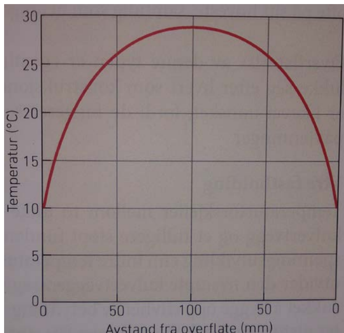
Figur 20. Typisk temperaturfordeling gjennom en 200 mm vegg ca. 1 time etter avforming. Lufttemperatur er 5 °C. [6]
