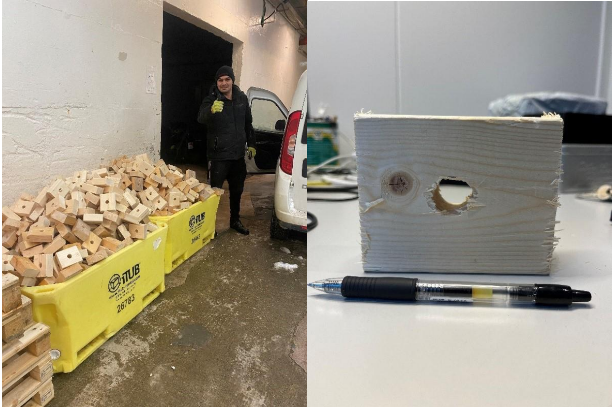
Figur 21: 1 Treklosser stabled i kar klar til å tres på kjetting. Foto: SINTEF
