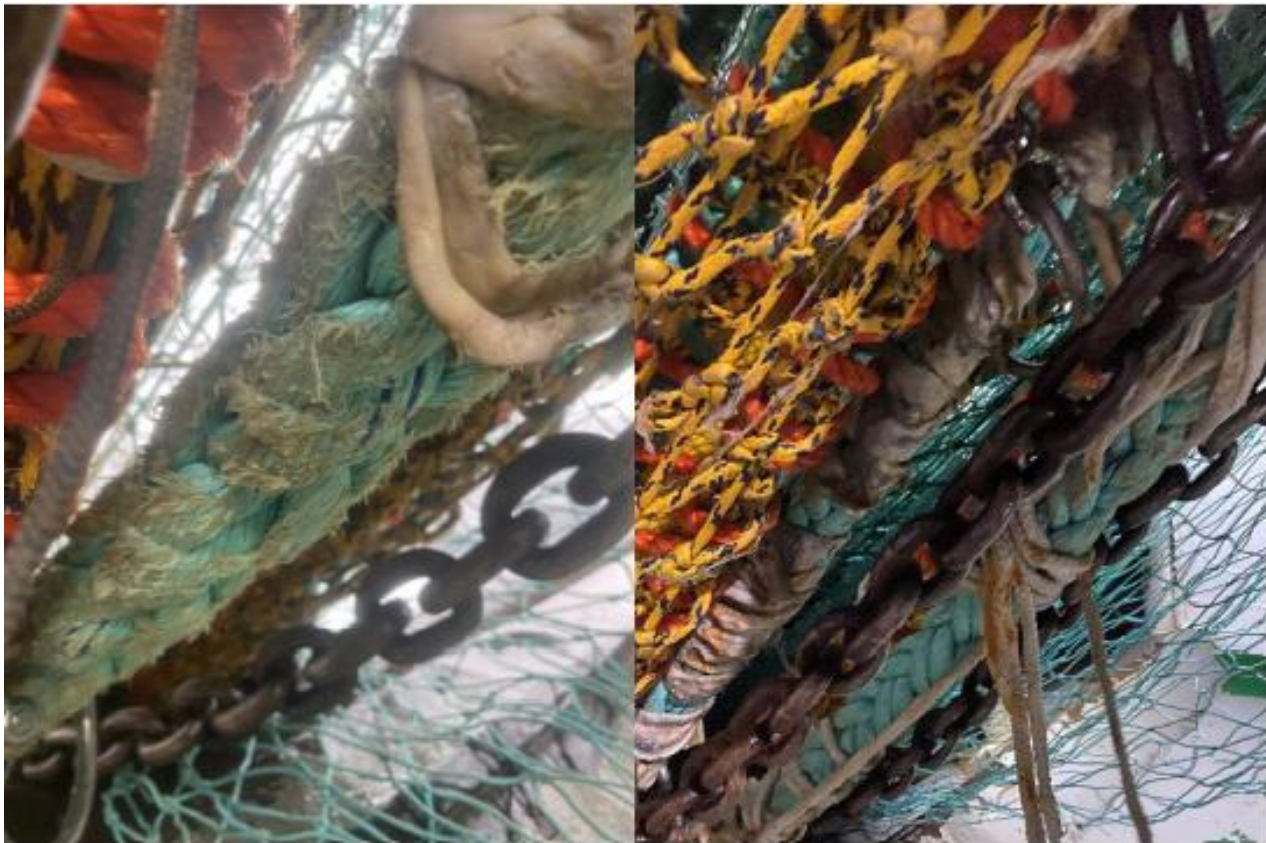
Figur 14: Etter hal 19 hadde referansestedene tydelig tegn til slitasje. En ser tydelig forskjell på styrken i kuskinn og trefibertau. Kuskinn holder seg fremdeles ganske bra, mens trefibertau er utslitt.
