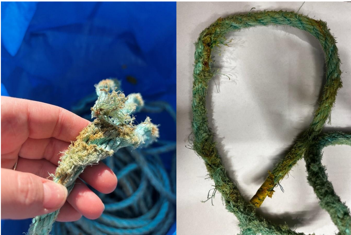
Figur 31:11 Slitasje på Danline etter bruk. Foto: SINTEF
