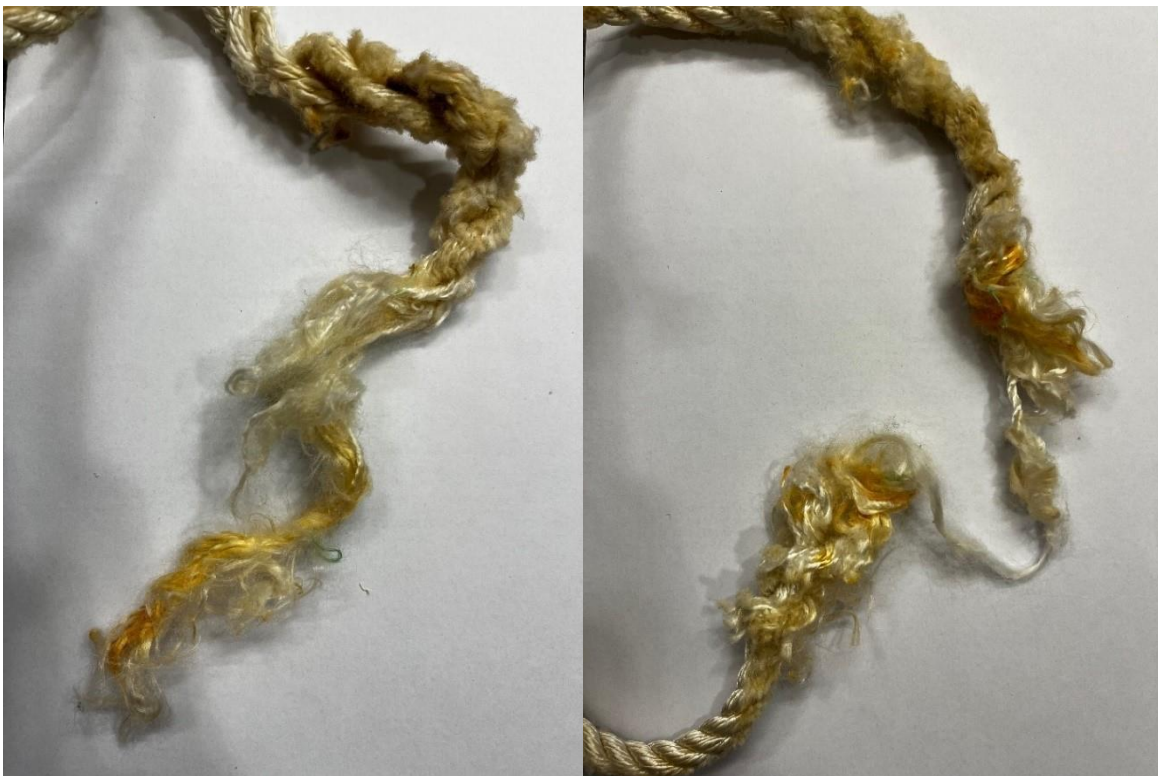
Figur 33:13 Slitasje på nylon etter bruk. Foto: SINTEF
