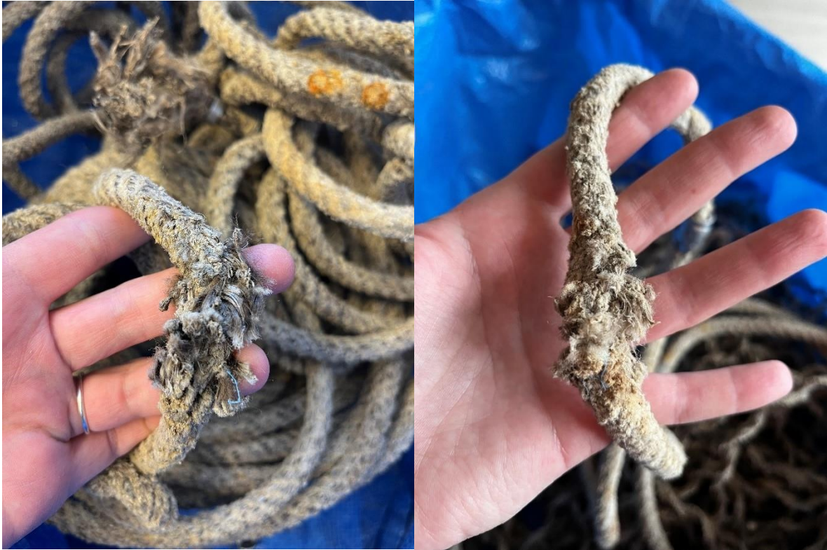
Figur 30:10 Slitasje på autoline etter bruk. Foto: SINTEF
