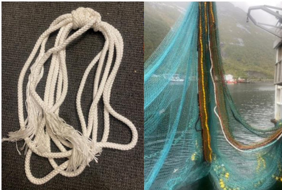
Figur 12: Trefibertau (til venstre). Sabben ferdig bolset (til høyre) med trefibertau i hvitt på høyre side av sabben og kuskinn på venstre side. Foto: SINTEF
