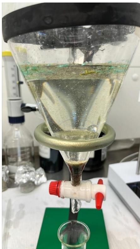
Figur 29:9 Eksempel på oppsett i lab. Skilletrakt med prøve av sediment og plastfragment, i dette tilfellet Danline. Foto: SINTEF
