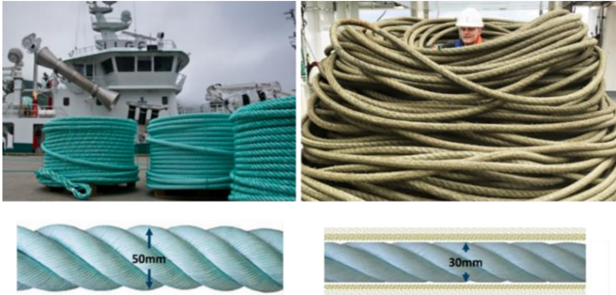
Figur 1: Nytt snurrevadt (til venstre) og brukt (kassert) snurrevadt (til høyre). Foto: Fiskeridirektoratet.
