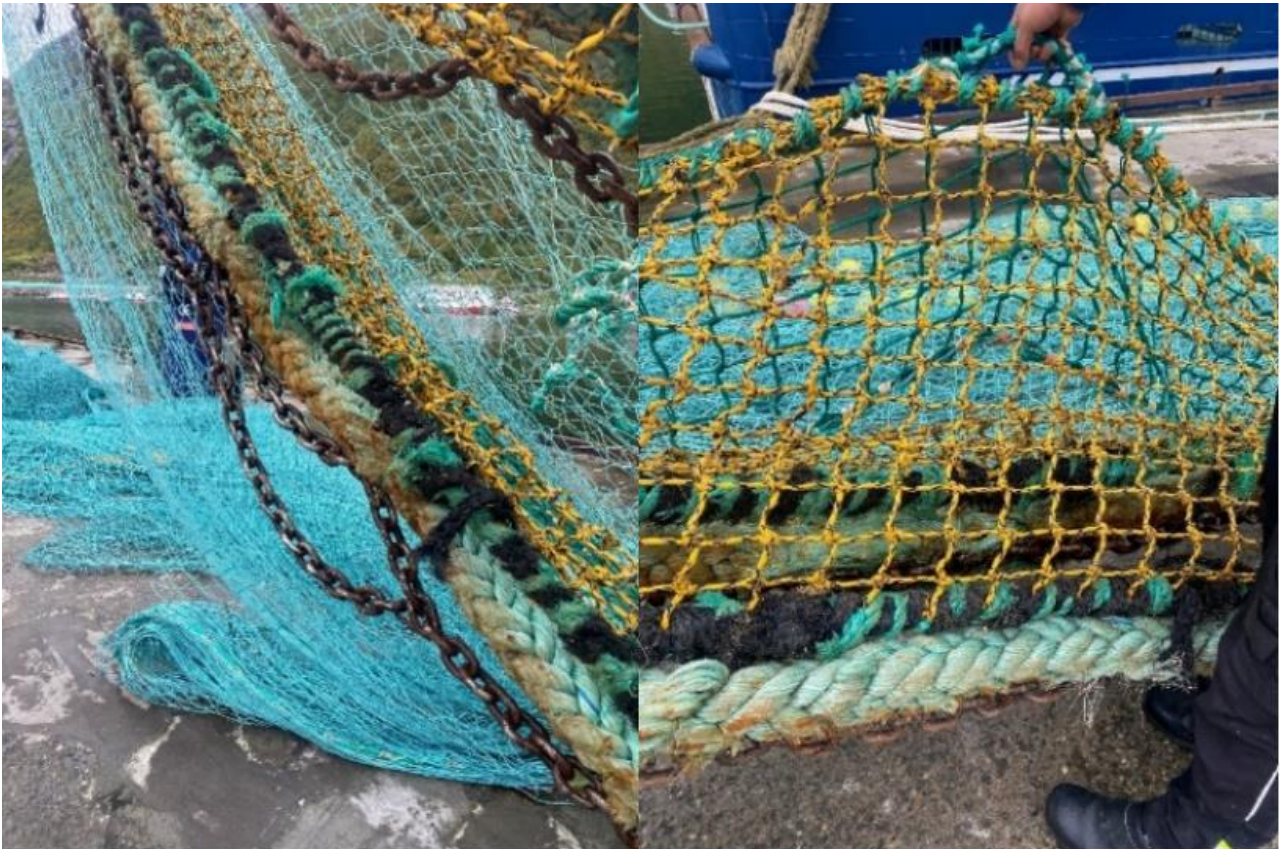
Figur 10: Nederst på skjørtet henger kjettingen som holder nota på bunnen, og ovenfor kjettingen er sabben (tykk grønn fletta trosse). Sabben soper langs bunnen når nota dras frem, og skal forhindre at skjørtet og nota rives dersom skjørtet huker seg fast i noe på bunnen. Foto: SINTEF
