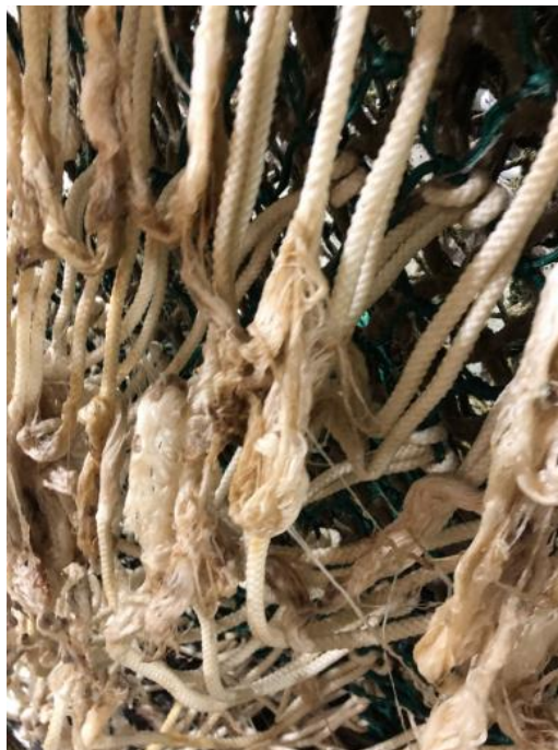
Figur 17: Endene på trefibertauet er tydelig påvirket etter 3 hal. Foto: SINTEF
