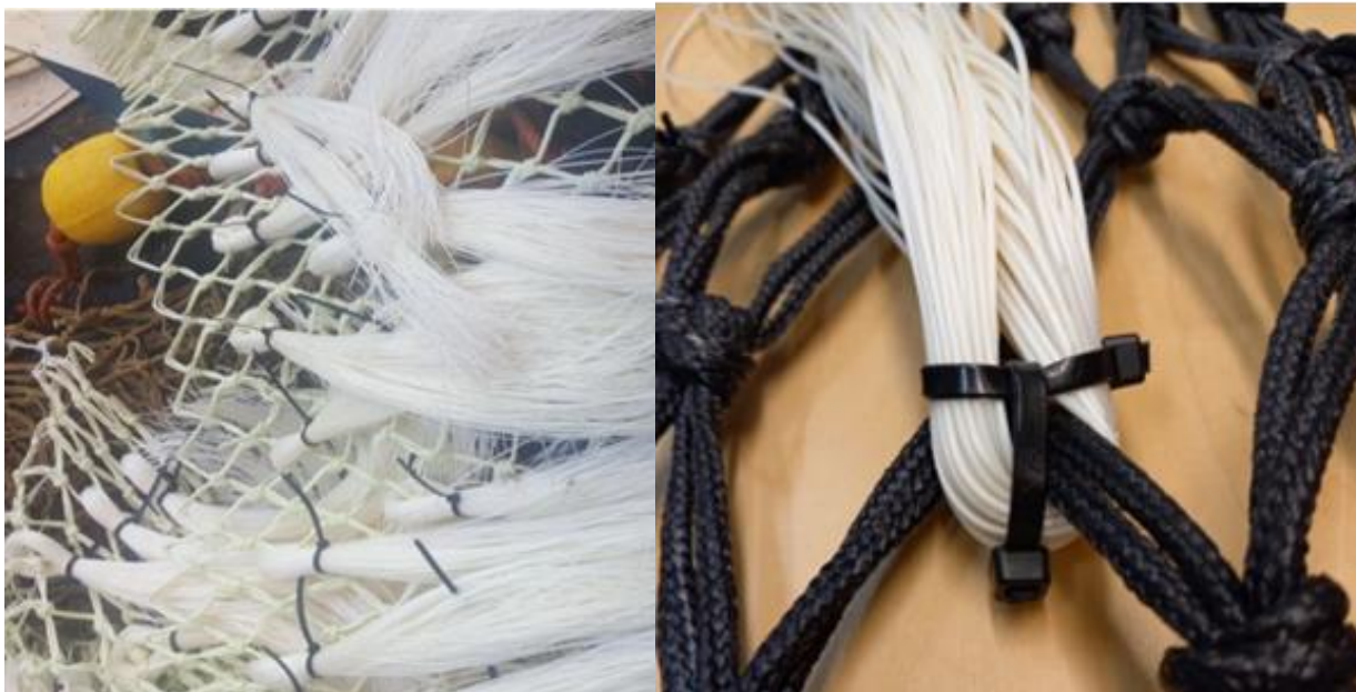
Figur 37: 17 Montering av BioPES vha strips i forsøk gjennomført i november 2022 (til venstre) og februar 2023 (til høyre). Foto: SINTEF
