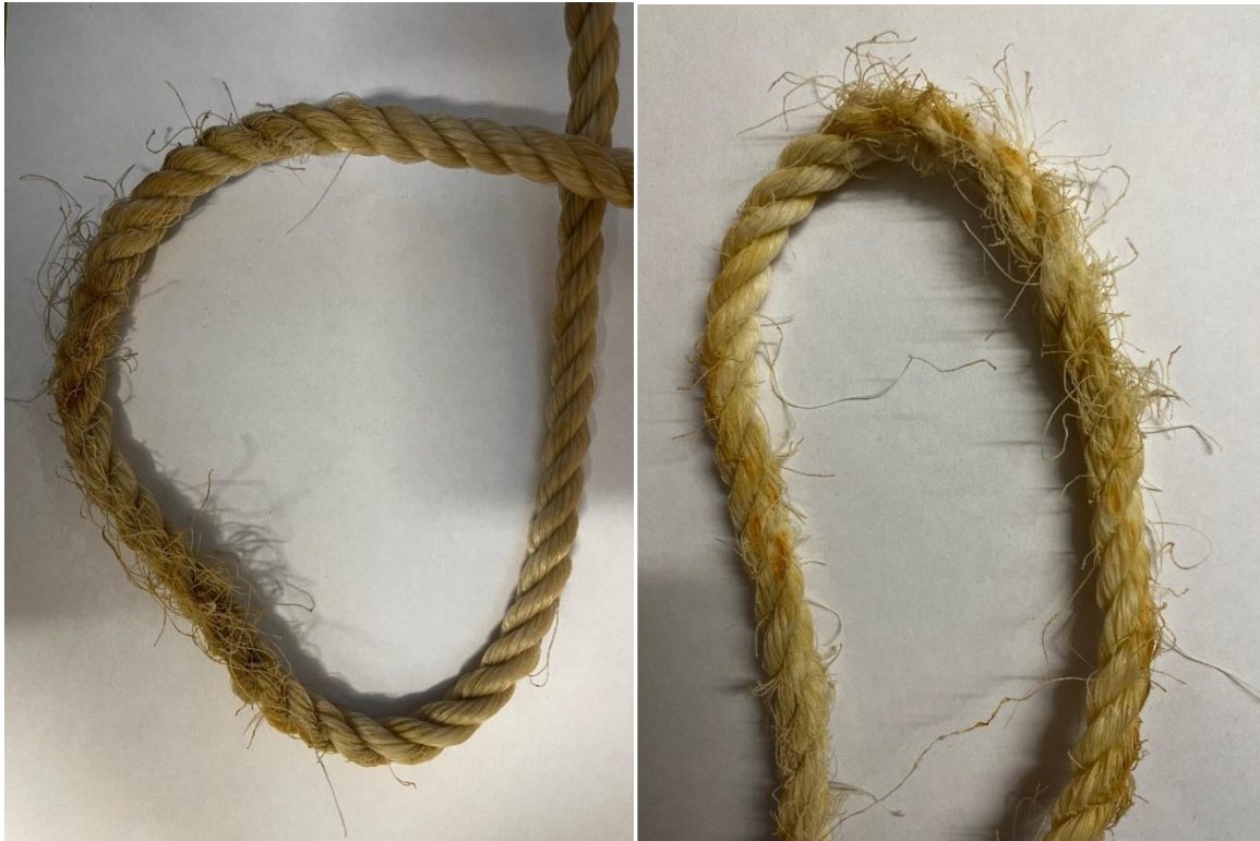
Figur 32:12 Slitasje på bionedbrytbart tau PBSAT1 fra Korea etter bruk. Foto: SINTEF
