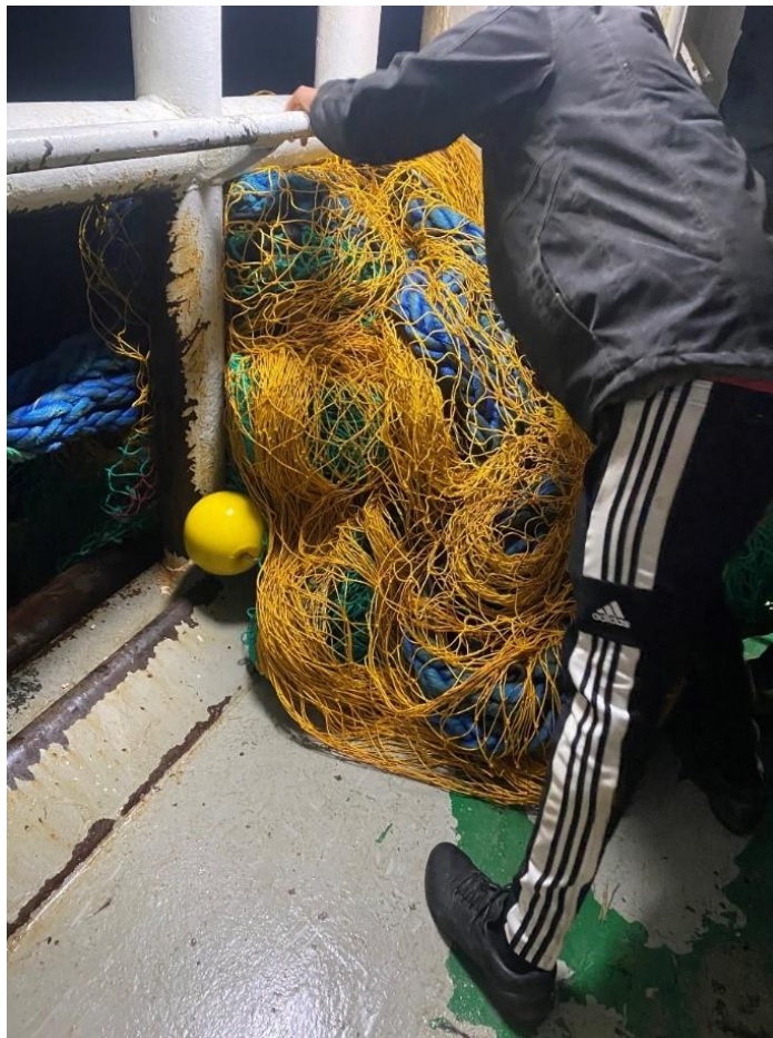
Figur 23: 3 Det bød på problemer å sette ut plankenota, i de fleste tilfeller måtte den vinsjes ut. Foto: SINTEF
