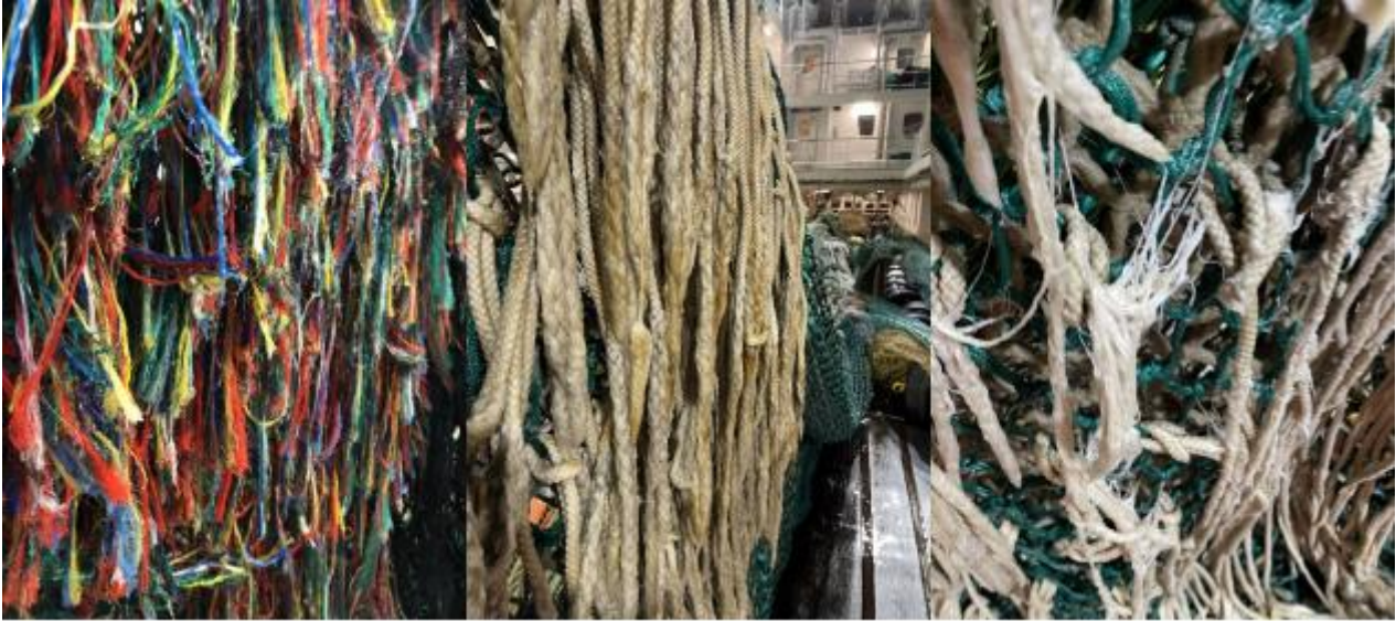
Figur 18: Nærbilder av labbetussene mot slutten av testserien. Slitasje av ulike karakterer. Foto: SINTEF
