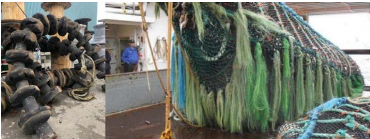
Figur 2: Trålgear (til venstre) og slitematte (til høyre) med synlige slitasjetegn. Foto: SINTEF
