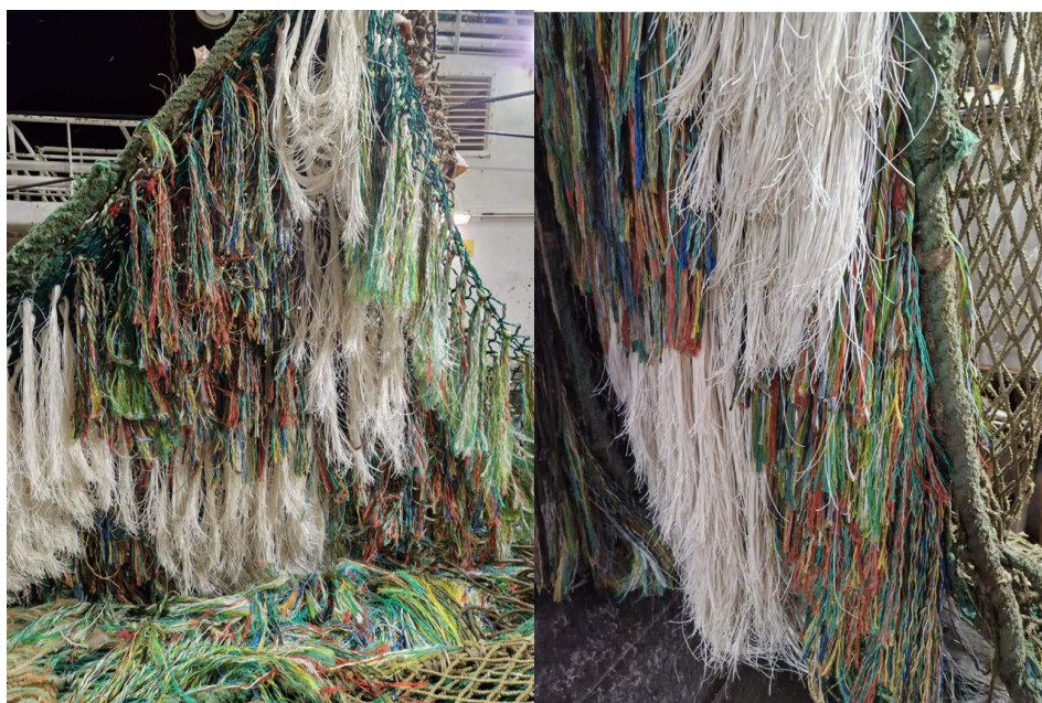
Figur 34: 14 Oppsett på labbetuss. Senbis BioPES i hvitt, standard labbetuss i multifarger. Foto: SINTEF
