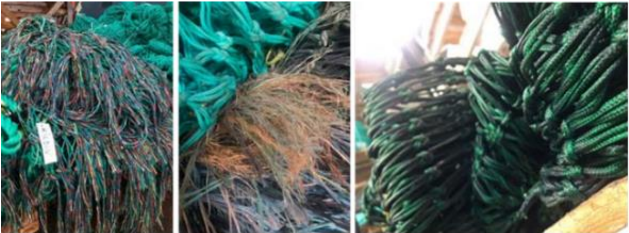
Figur 3: Bilde av ny (til venstre) og slitt (i midten) labbetuss (PE/PP/PET). Slitematte av impregnerert nylonnett (til høyre). Foto: SINTEF
