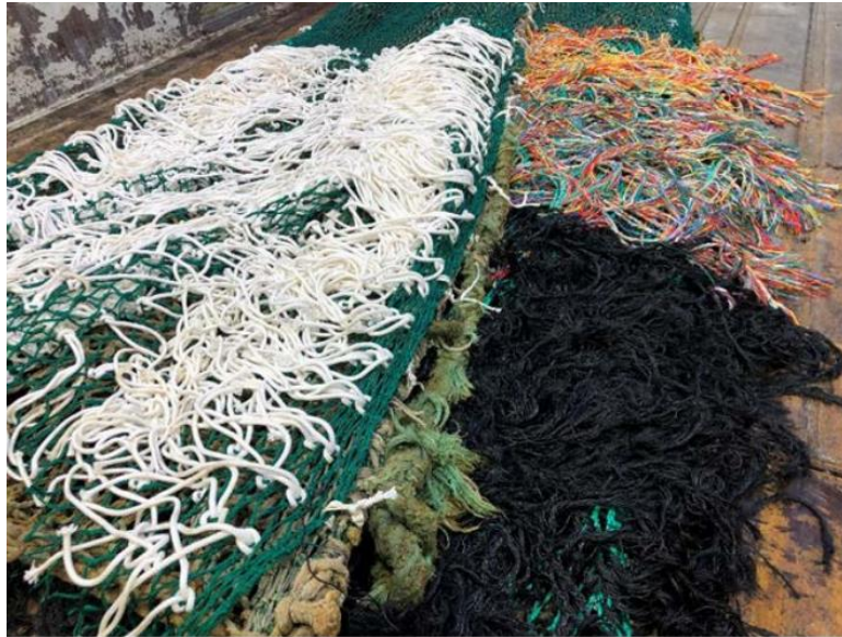
Figur 16: Labbetuss av trefibertau (hvitt) og vanlig labbetuss laget av polyetylentau (sort og farget) før forsøkene starter. Labbetuss er en slitematte som beskytter trålsekken mot riving i bunnen. Foto: SINTEF
