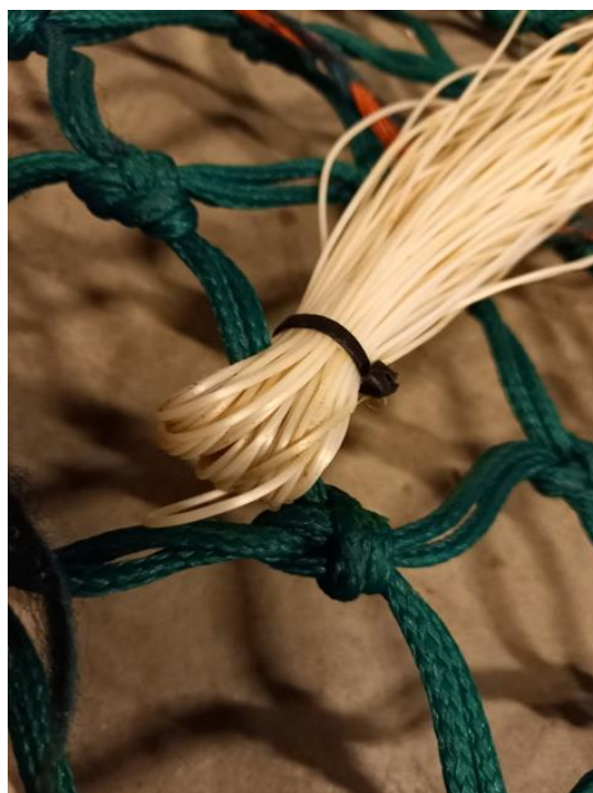
Figur 39: BioPES viser lite til ingen tegn til oppløsning eller slitasje. Foto: SINTEF
