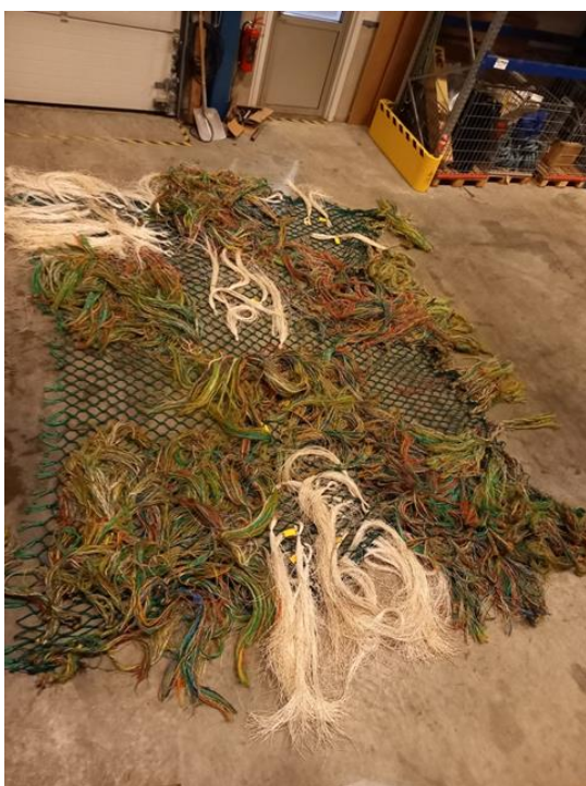
Figur 38: Labbetuss etter 4 ukers bruk i 2022. Legg merke til tapt tau av BioPES (i hvitt). Foto: SINTEF
