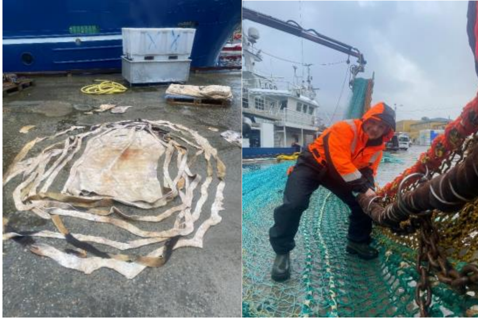
Figur 11: Skinet strimlet opp (venstre) før det surres rundt sabben (til høyre). Foto: SINTEF
