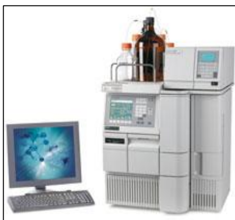
Figur 2 HPLC-systemet med Waters 2695 separasjonsenhet og 2996 fotodiodedetektor (Bilde: waters.com).
