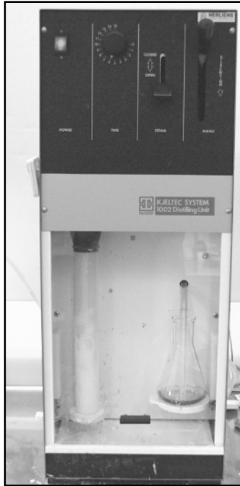
Figur 3 Kjeltech 1002 under destillasjonsprosessen. Kjeldalrør (t.v.), og E-kolbe med borsyreløsning (t.h.).
