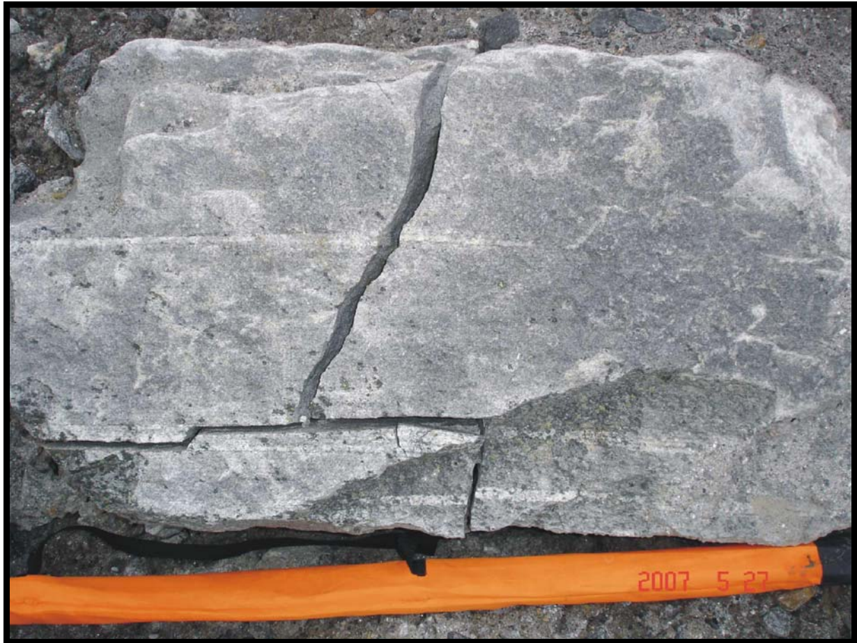
Figur 7-11 Oppknust blokk som lå på den sentrale delen av viften. Blokken er trolig knust av steinsprangmateriale. Oransje stav 1 m som målestokk.
