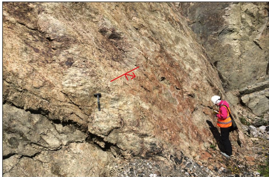
Figur 26: Foto av det blottede forkastningsplanet i steinbruddet. Planet preges av oppknust granitt, glidestriper og sekundært utfelt hematitt og kloritt. Planets orientering og bevegelsesretning er vist med det røde tegnet.
