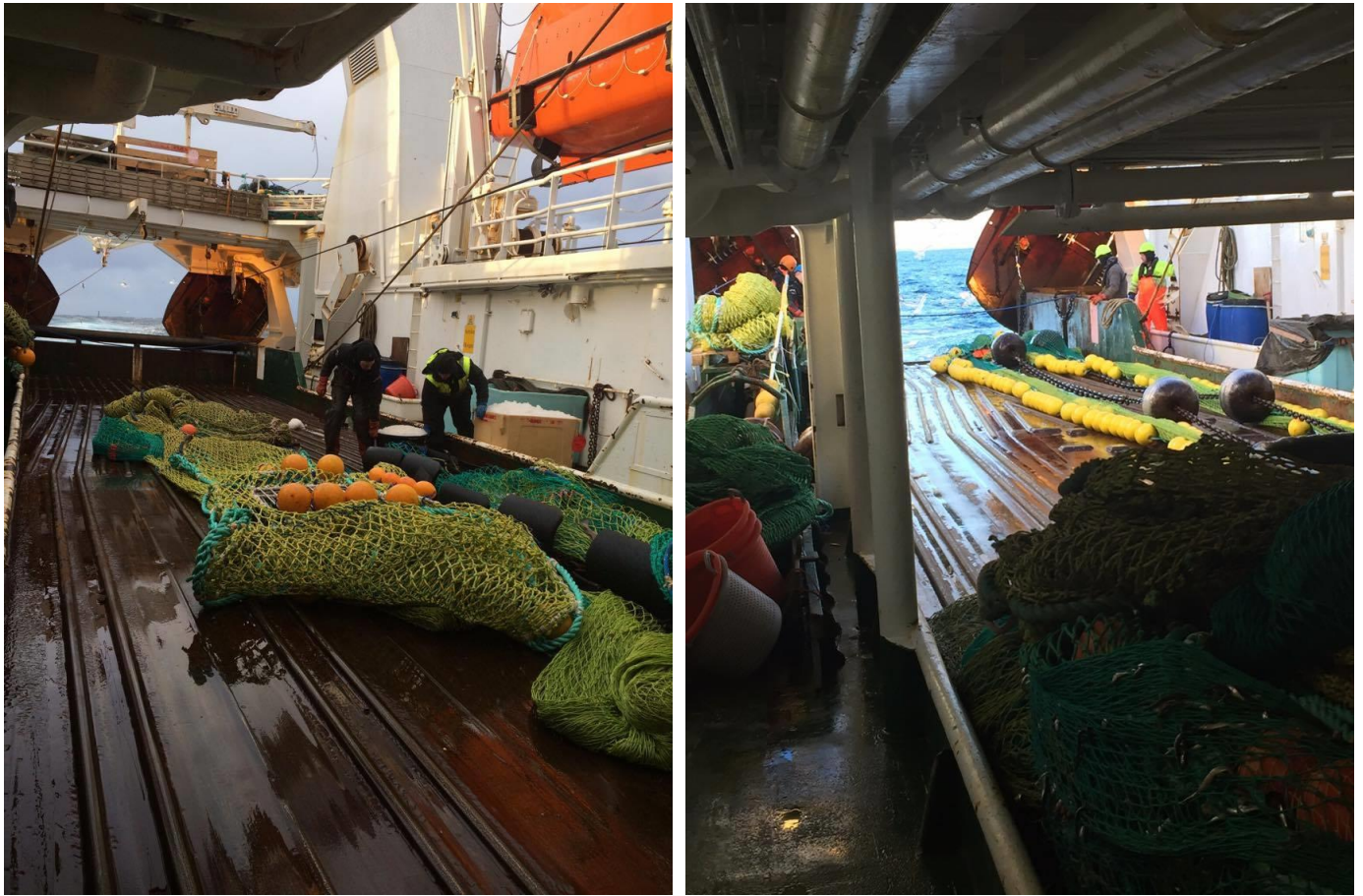
Figur 9. a: Trålen inspiseres ute på dekk. Sorteringsrista ligger under oransje fløytkulene. b: Den mørke kjettingen har stålkuler som hjelper å holde giret i kontakt med havbunnen. De gule fløytkulene er festet til trålens «headline» og hjelper å holde nota åpen. Tråldørene henger bak båten. Foto av undertegnende.
