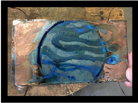
Figur 23. Restplate av kobber som jeg brukte som lokk på et syltetøyglass med salmiakk i.
