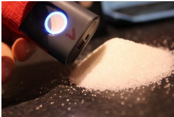
Figur 4 - Bilde av en SCiO som gjør en måling av et ukjent stoff
