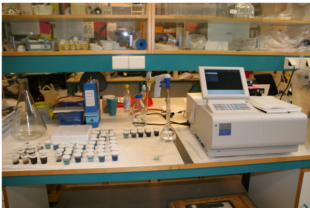
Figur 15. Bilde av laboratoriesituasjonen. Til høyre ses spektrofotometeret som var i bruk, mens det til venstre ses flere ferdigreagerte prøver.
