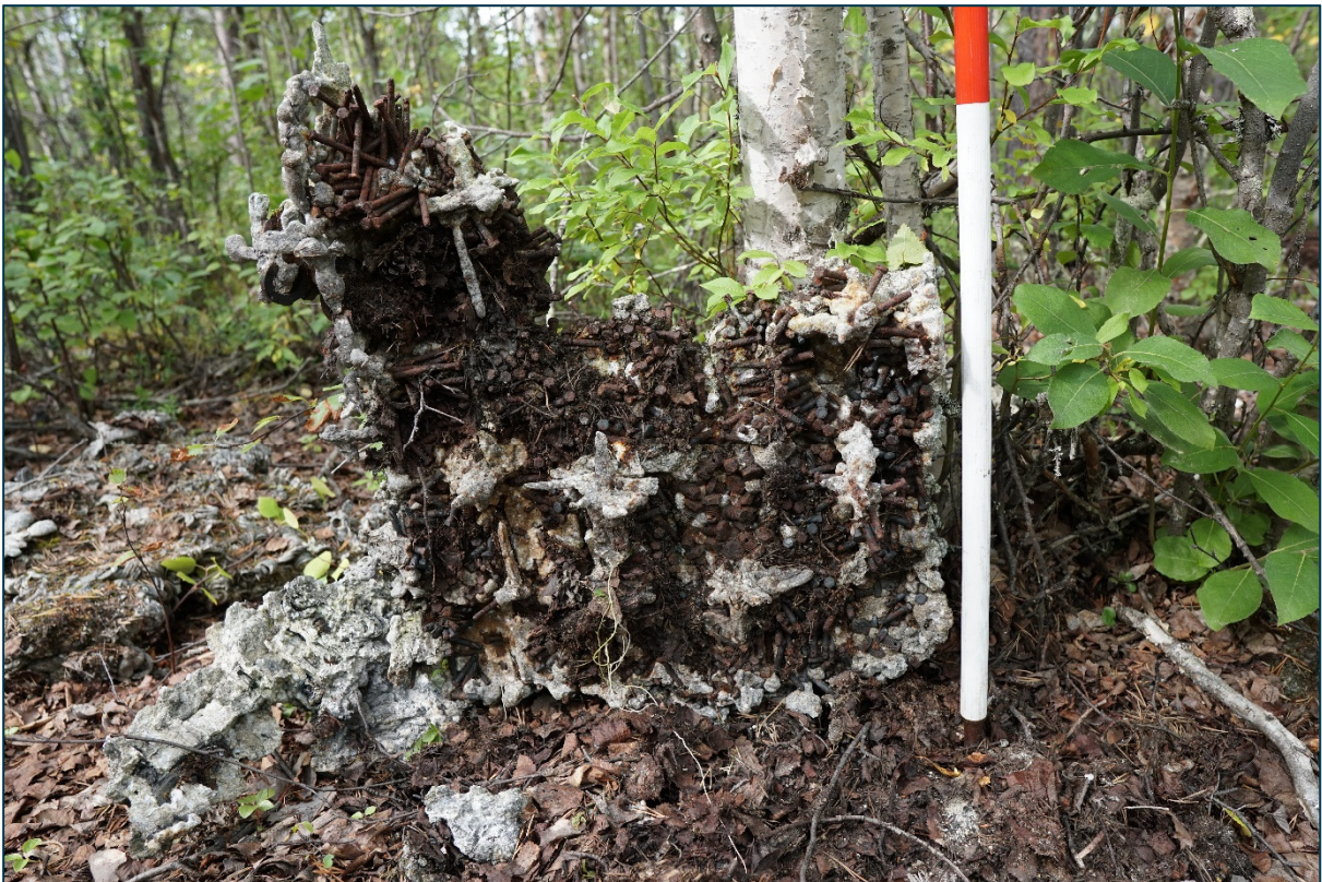
Figur 51 Depot 10612. Store mengder med spiker, bolter, skruer og annet materiale har blitt smeltet til et konglomerat av ulike metall.
