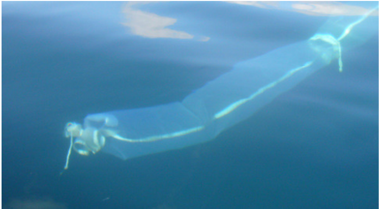
Bilde 5: Sekken under tauing i lav fart. Ikke overtrykk inni sekken da denne ikke er spilt ut.
