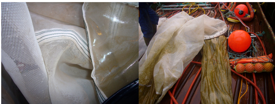
Bilde 6: T.v. Forskjellen på algemengde i nettet på 1080 \mu\text{m} , 750 \mu\text{m} og 475 \mu\text{m} . T.h. Klar forskjell på alger på det grove nettet langt frem i trålen, og det fine nettet bak. Bildet t.v. viser 1080 \mu\text{m} , 750 \mu\text{m} og 475 \mu\text{m} . På bildet t.h. sees de brune algene i nettet med maskevidde 475 \mu\text{m} mot dekket, mens det hvite nettet over har 750 \mu\text{m} maskevidde.
