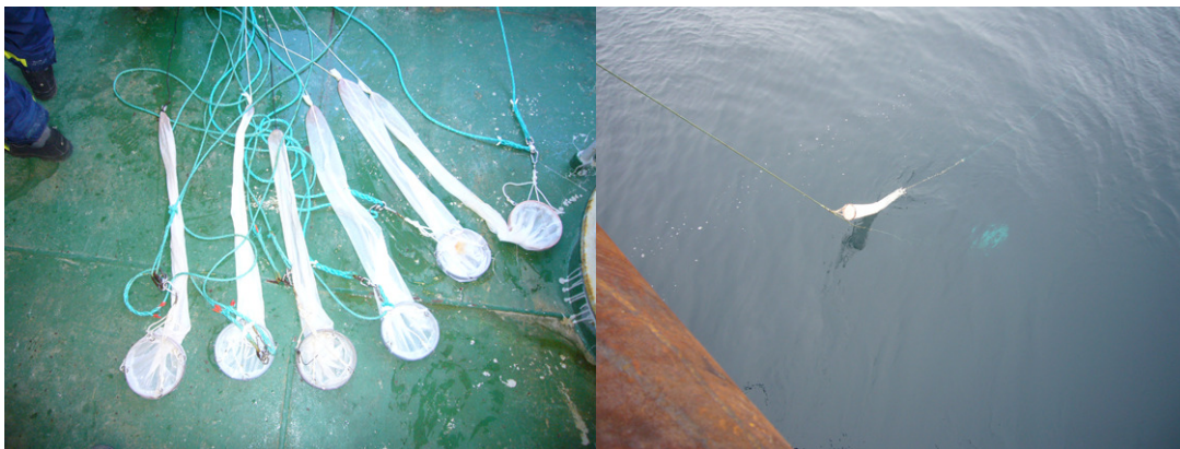
Bilde 4: Planktonmeter for lokalisering av raudåte. 6 håver ble festet med 3 eller 5 meters mellomrom og tauet i 15 min.
