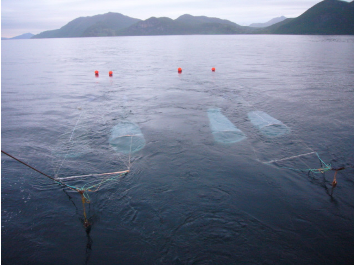
Bilde 3: To modelltråler taues i hver sin slepewire adskilt med et børtre. Slepewire og lodd festes i forkant av børtre. Slag til blåser festes i aluminiumsringene. Bildet er tatt ved skyting av trålene.
