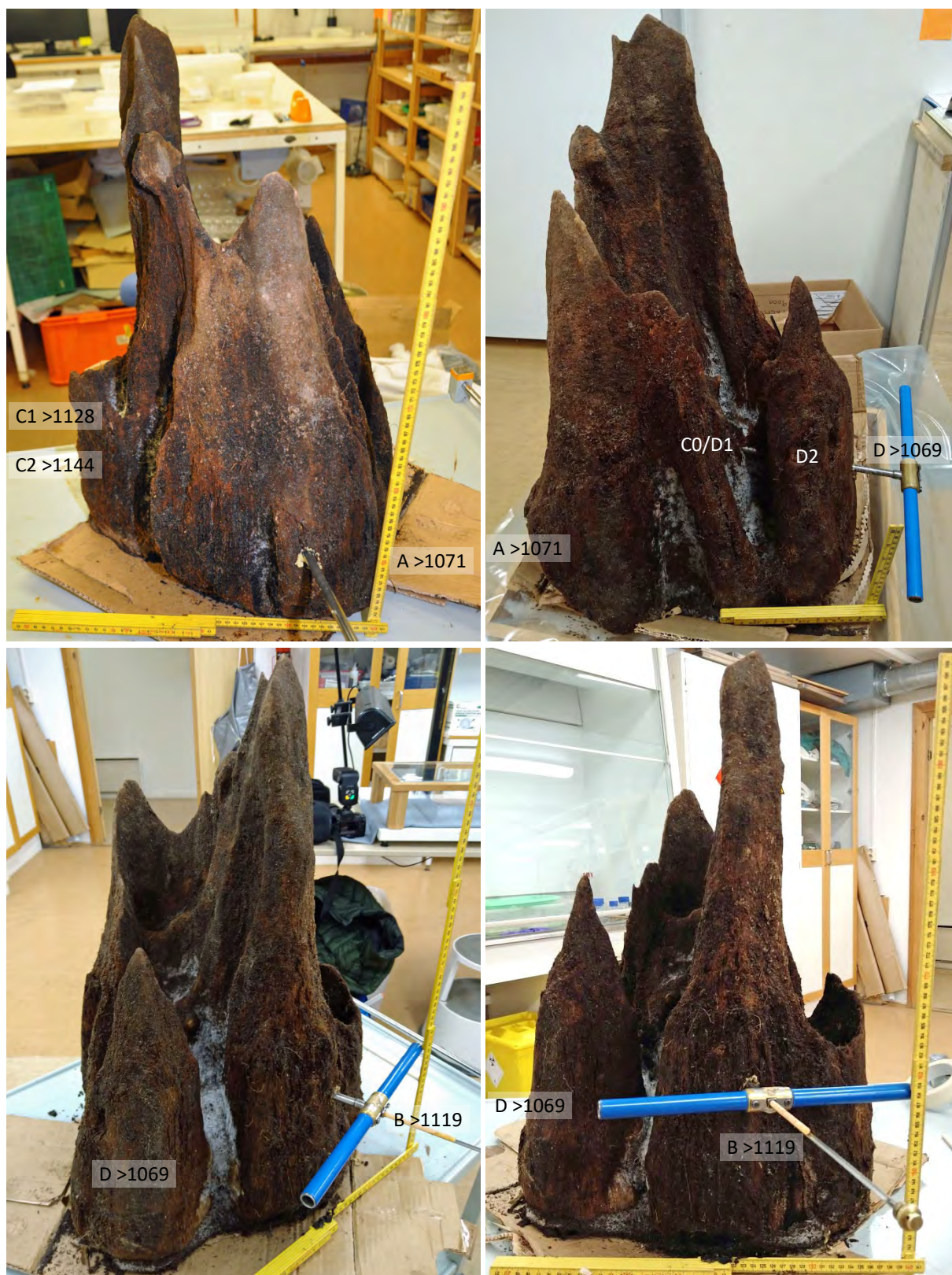
Figur 8a: Stolpen og prøveuttak. Prøvene markert med bokstavene A-D, etterfulgt av dateringen for siste målte årring.
