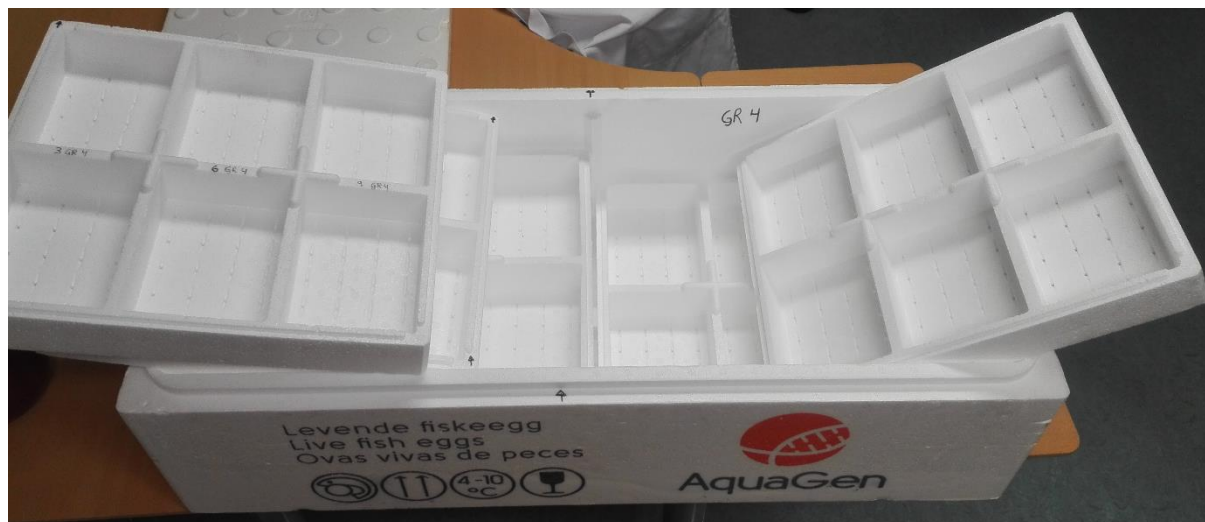
Figur 3. Transportkasse fra AquaGen. Kassen bestod av seks brett med seks adskilte rom. Bunnen av hvert rom var perforert slik at smeltevannet fra isen i øverste hylle kunne sile til brettene under, og rognen holdt seg fuktig under transporten.
