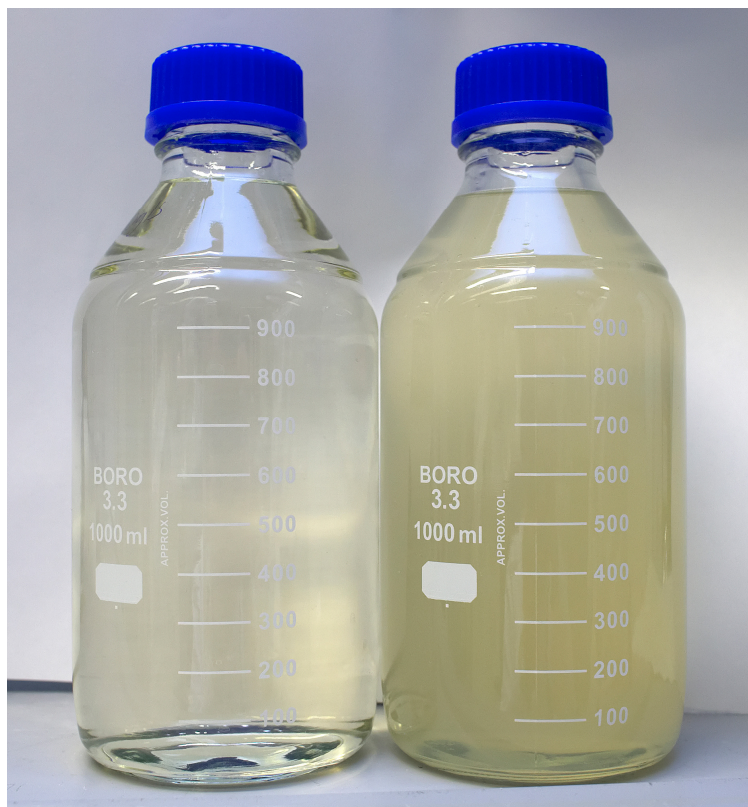
Figur 17: Før og etter filtrering av avløpsvann. Prøven til høyre er ikke filtrert. Foto: Kristian L, Forsberg
