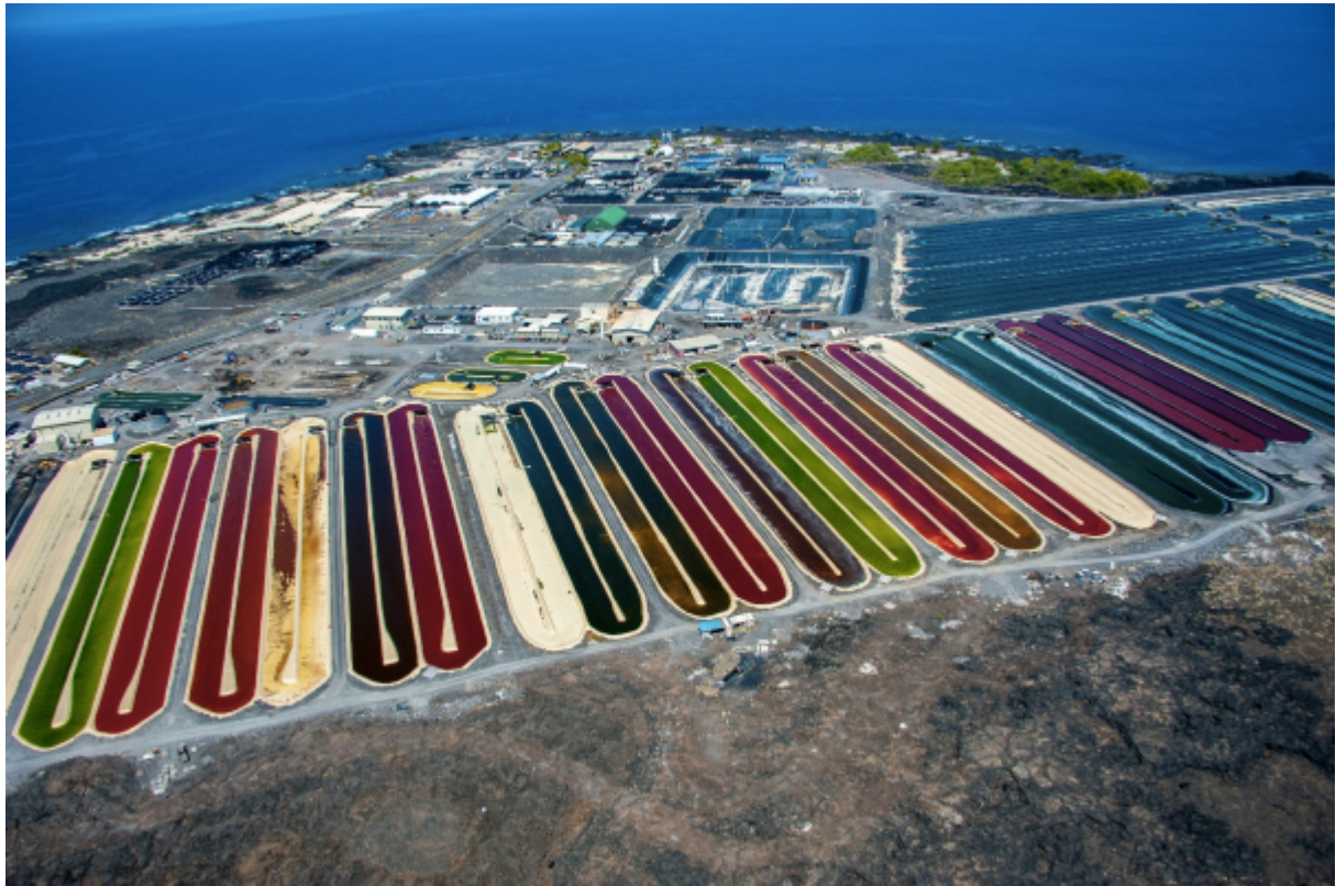
Figur 3. Tradisjonell industriell produksjon av alger i åpne dammer. (Hentet fra Cyanotech).
