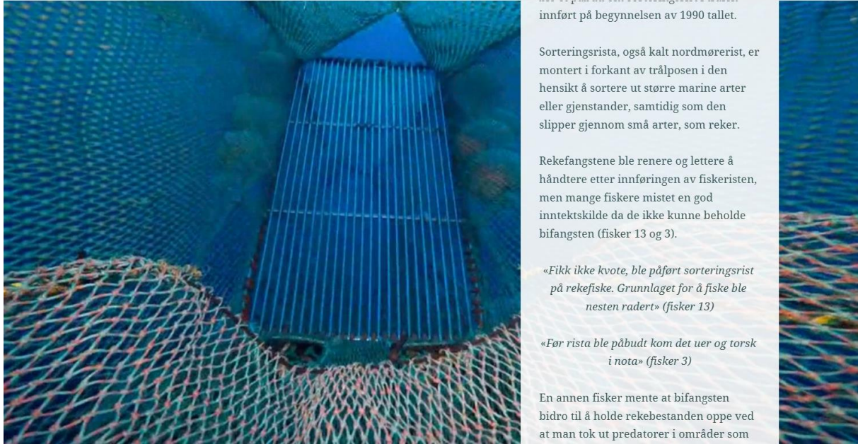
Figur 9 Skjermdump av skillerist i rekeetrål. Foto: Roger B. Larsen.
