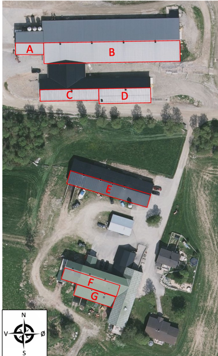
Figur 3-4: Egnede takområder for installasjon av solcellepanel på Galåvolden Gård og Galåen Samdrift (Skjermdump: Norgeskart)
