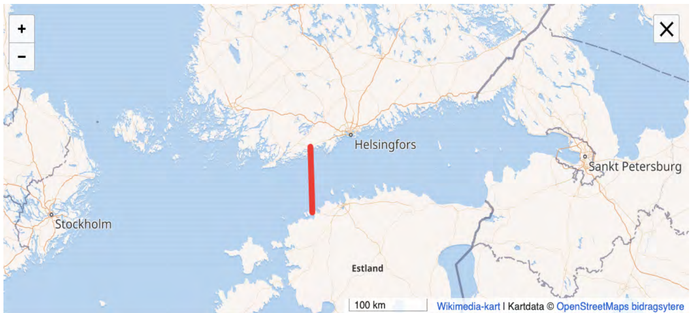
Balticconnector er en naturgassledning under Finskebukta mellom Ingå i Finland og Paldiski i Estland, og som forbinder naturgassnettet i de to landene. Den har også tilknytning også til Inčukalns underjordiske naturgasdepot i Latvia. Ledningen ble satt i drift i januar 2020. Foto: © OpenStreetMap-bidragsterene.
