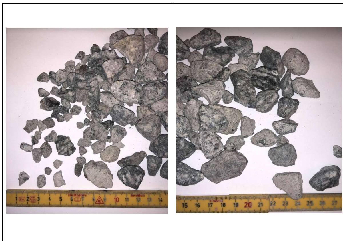
Figur 4.1-1: Resirkulerte tilslagets karakteristikk av større fraksjon, etter vask ( > 5 mm).
