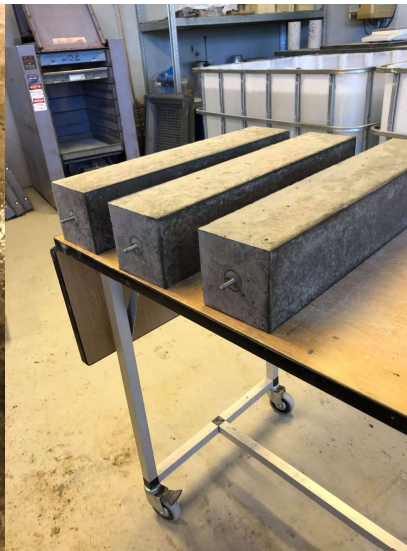
Bilde 5 Avformet, godt komprimert
