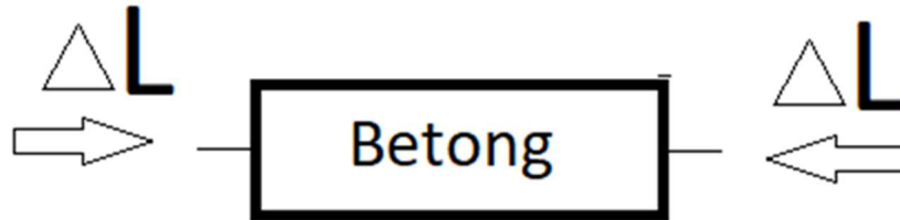
Figur 3.6-2: Svinnet gjennom herdeforløpet vil føre til kontraksjon av betongen og lengdeforandringen måles.
