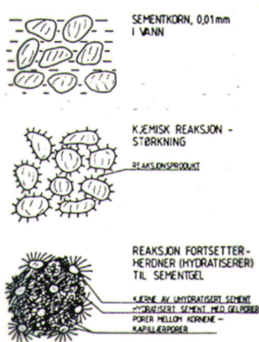
Figur 2.1-1: Hydratiseringen av sement (Arntzen, 2018).
