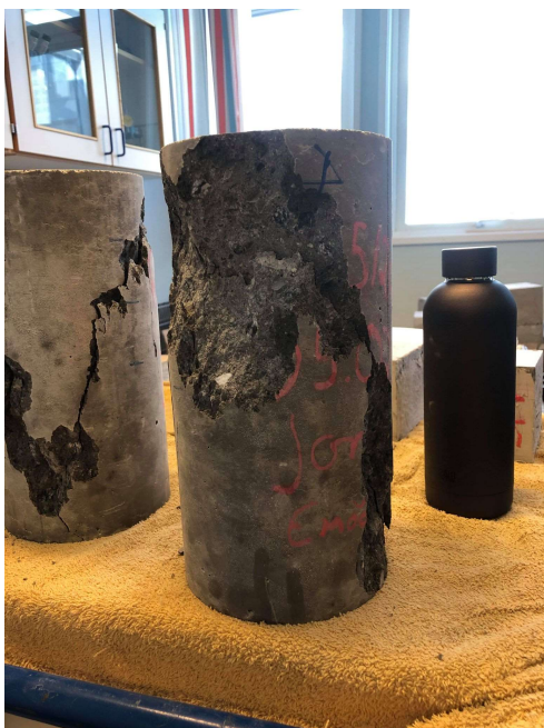
Bilde 9 Feilbrudd, eksplosivt tverrbrudd 90 d E-mod RCA 5/20
