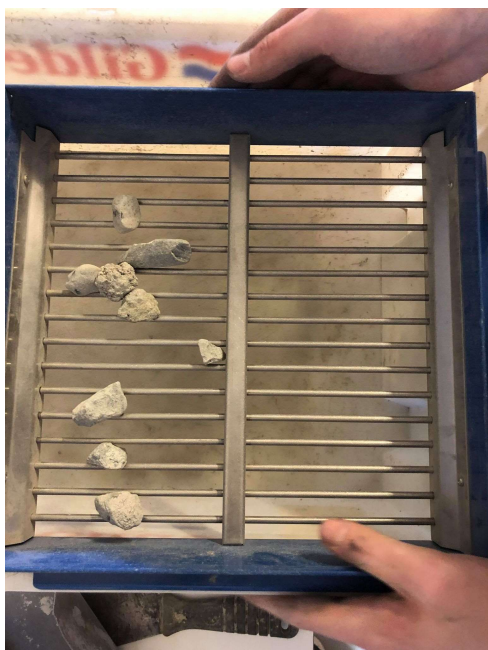
Bilde 11 Gjennomføring av flisighet
