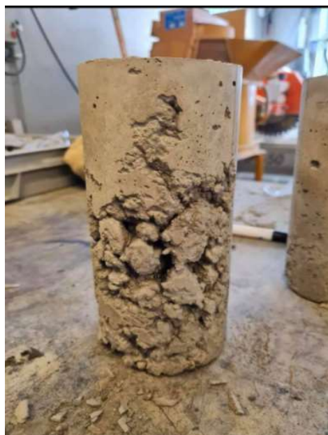
Bilde 8 Dårlig form/feil komprimert
