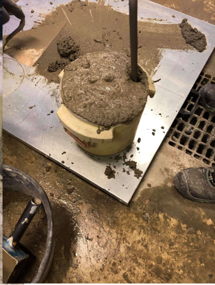
Bilde 3 fylling av form til luftinnhold
