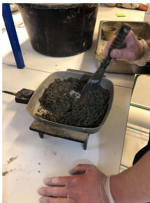
Bilde 10, tørking av sand 0-4 for vannabs.
