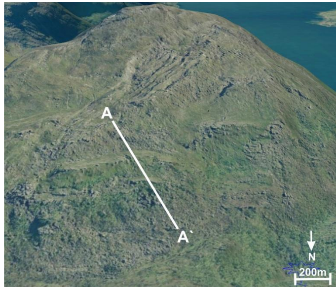
Figur 5.10: 3D-modell over skredet i Laksvatnfjellet, som viser profillinjen (a) gjennom nedre deler av skredet.
