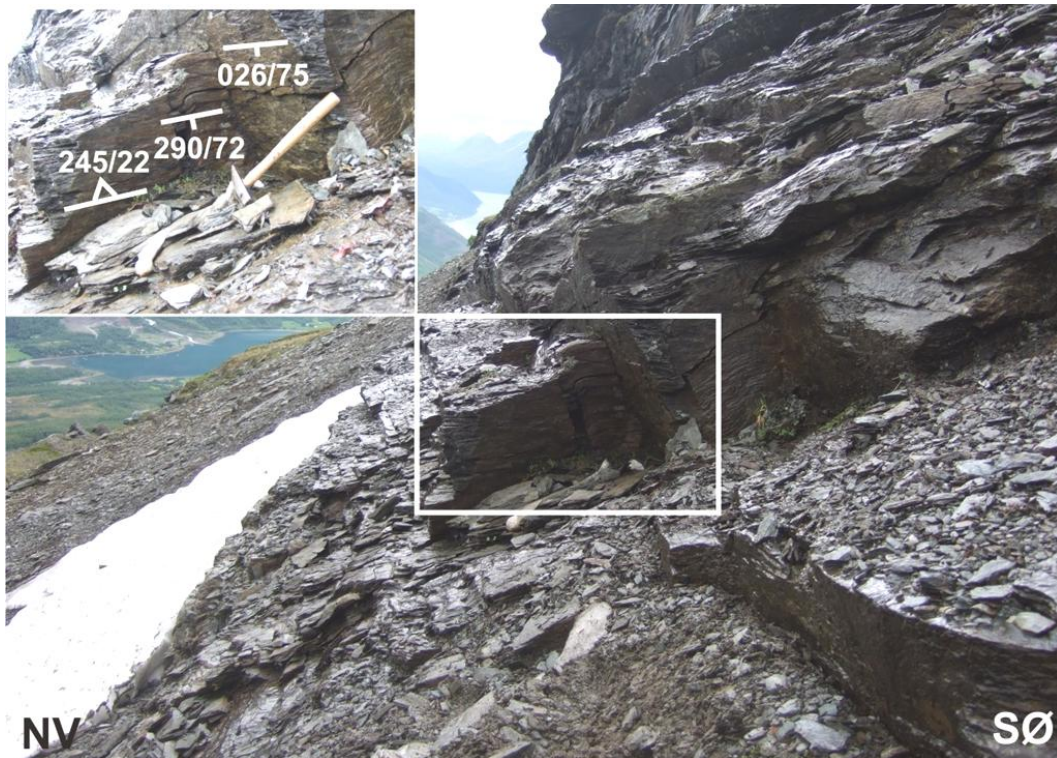
Figur 4.12: Foldet og krenulert metapellitt fra bakskrenten. Utsnitt viser innrammet område i bakskrenten. I utsnittet er det to tydelige bruddplan (sprekker) med bratt til meget bratt fall. Det ene bruddplanet (026/75) følger krenulasjonskløven (akseplan til åpne asymmetriske folder) i berggrunnen. Det andre bruddplanet (290/72) er orientert normalt på krenulasjonskløven og selve bakskrenten, og er parallell med tverrsprekker i øvre og midtre del av skredet (se kap. 4.3.4.).
