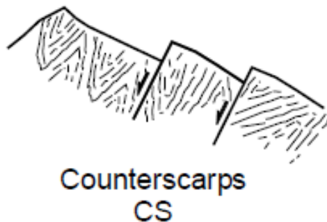
Figur 5.2: Illustrasjon av flere antiskrenter ( anticarp/counterscarp ) (Agliardi et al., 2001), som faller inn mot fjellsiden. Merk dip-slip bevegelse mellom blokkene.
