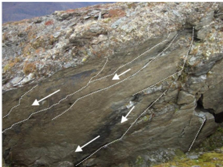
Figur 4.10: Tverrsnitt gjennom en liten del av berggrunnen i skredet, som viser et mulig sammenhengende glideplan med trappetrinnsgeometri, som følger steile sprekker i berggrunnen og lavvinklede foliasjonsplan.
