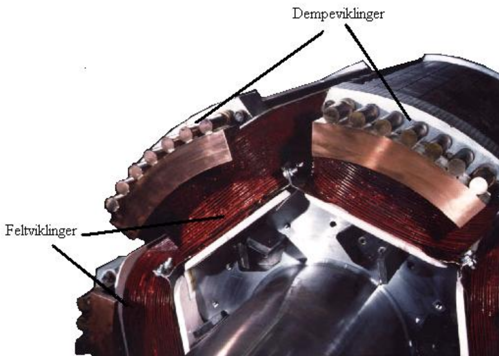
Figur 11.5: Rotor med feltviklinger, dempeviklinger og utpregede poler
