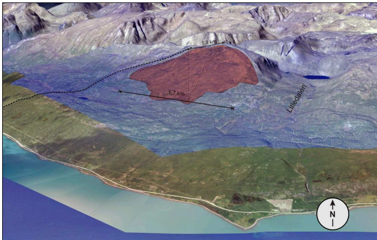
Figur 2.2 Foto som viser skredets utbredelse i Nomedalstinden. Et tydelig lineament utenfor skredet er tegnet inn som en sort stiplede linje. I øst vises Litledalen og vannet som ligger innerst i dalen (fra Norgei3D.no).
