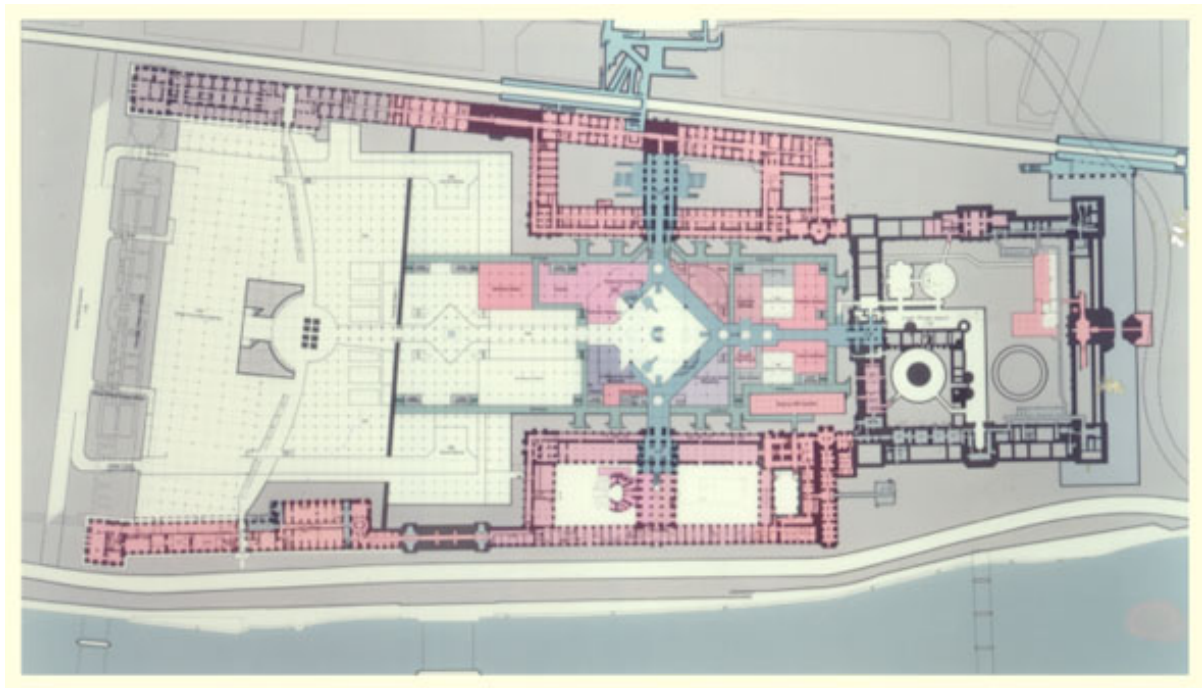
Figur 17. Plantegning av Louvre-anlegget og vestibylen, også kjent som Napoleon-hallen. Fra midten av vestibylen under pyramiden går det passasjer til utstillingsrommene i de omkringliggende bygningene og mot venstre til den omvendte pyramiden. Rundt pyramiden er det areal til diverse rom. Glasspyramidens sider er 35 meter lange, mens selve vestibylen har et samlet areal på ca. 55 750 kvm fordelt på to plan. 44
