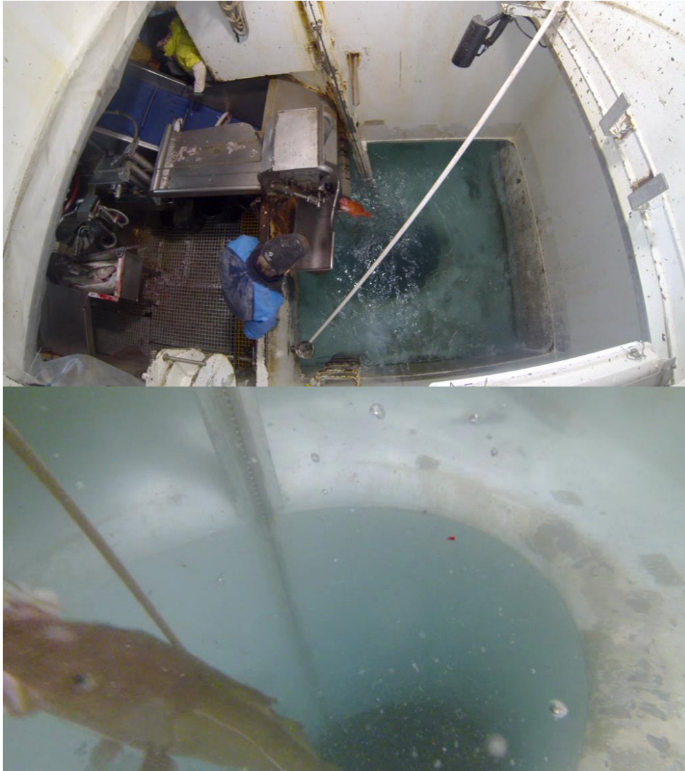
Bilde 9. Øvre del av bildet viser dragebrønnen sett ovenfra om bord M/S Carisma Viking. Nedre del av bildet viser åpningen til dragebrønnen under vann, med skinnen for å ta inn ilen synlig. (Foto: Roger B. Larsen)
