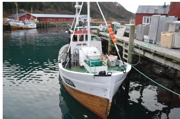
Bilde 13: En eldre kystbåt rigget for line (Foto: Jørgen Vollstad, SINTEF).
