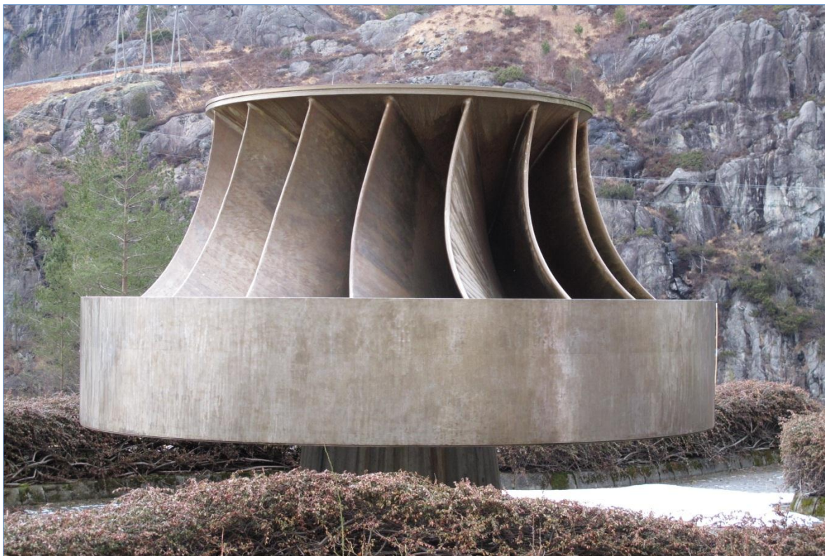
Francisturbin lik de som er i drift ved Åna-Sira kraftverk. Foto: Eva. B. Thorstad.
