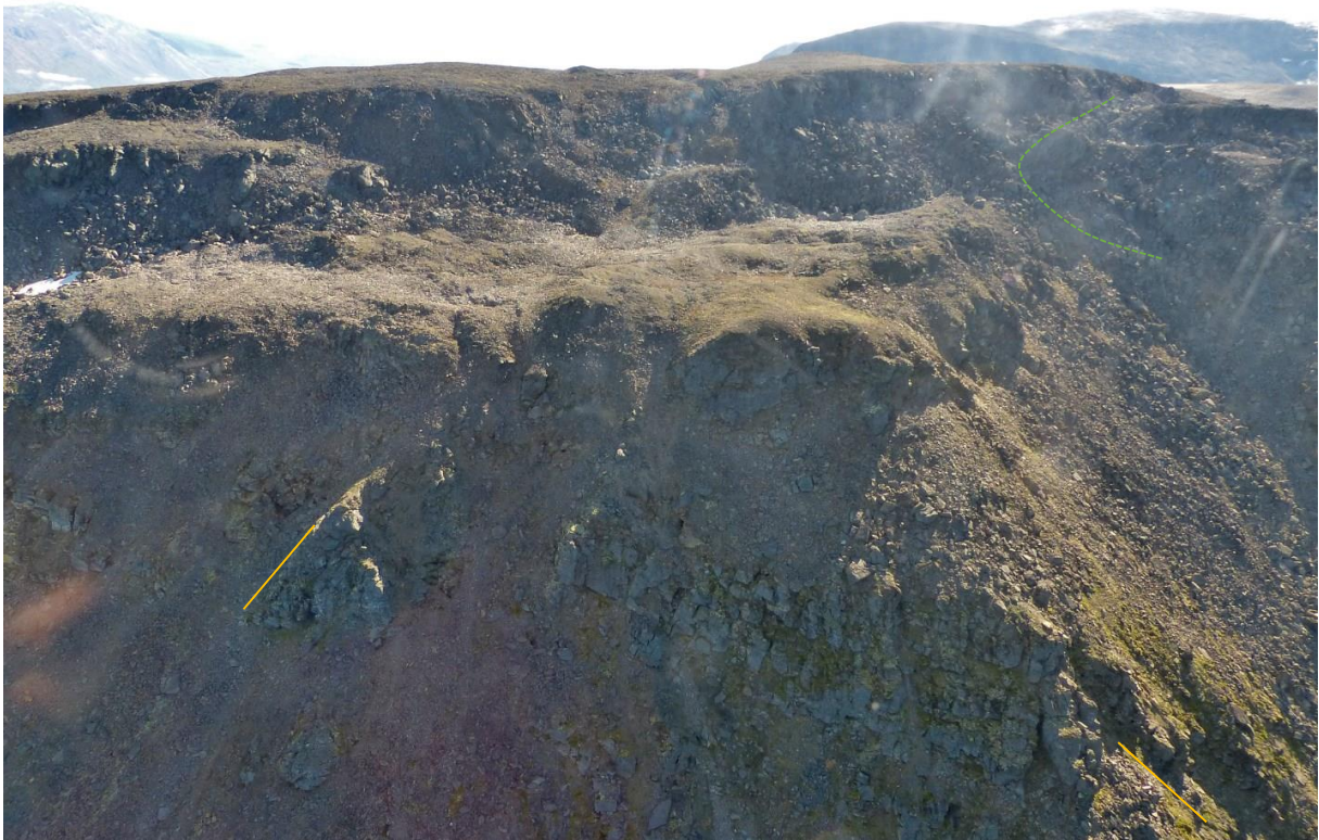
Figur 3.4.6 Bilde tatt mot SØ. Nedglidd fjellparti, blokk E 1 midt i bildet foran. Kan skimte blokk E 2 oppe til høyre (grønn linje viser omriss). Legg merke til «joint saturated» berggrunn nede i fjellpartiet. Glideplan sees ned til høyre, ned til venstre (gule linjer) og utrasing rett mot. Lineamenter på E 1 flaten.
