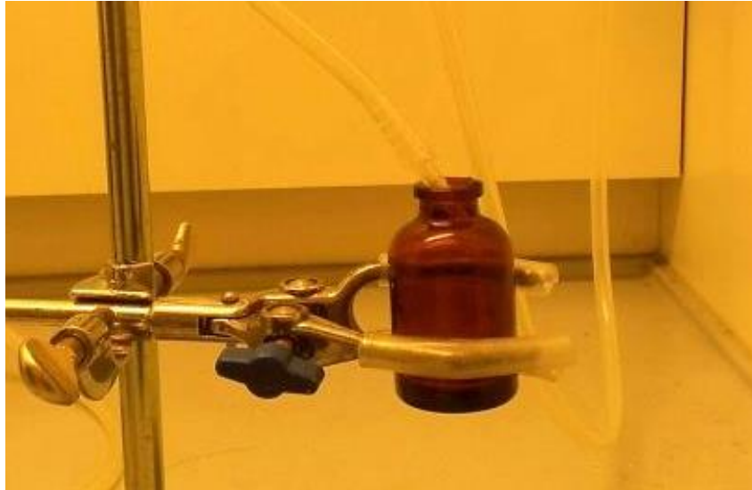
Figur 11. Bildet viser monteringsoppsettet for avdamping av etanol under en strøm av nitrogengass i hetteglasset. Blandingen ble tilført nitrogen via en slange opp i injeksjonsglasset, som vist på figuren.
