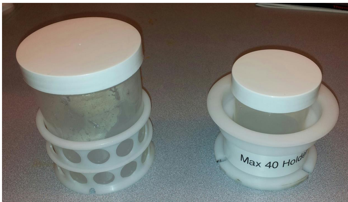
Figur 14. Til venstre i bildet vises en M100-kopp i beholder beregnet for DAC. Til høyre sees en M40-kopp i beholder beregnet for DAC
