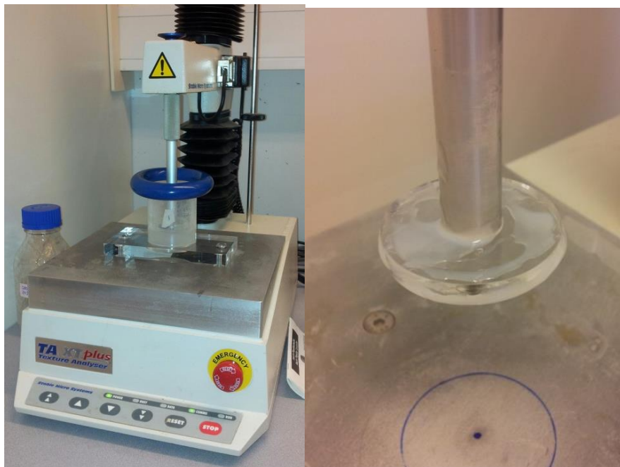
Figur 15. Venstre: teksturapparatet TA.XT plus med DP-kopp montert i tilhørende monteringsoppsett. Høyre: Kompresjonsstempelen på 40 mm i diameter som ble benyttet under analysene. Under kompresjonsstempelen sees diameteren til M40-kopp tegnet inn
