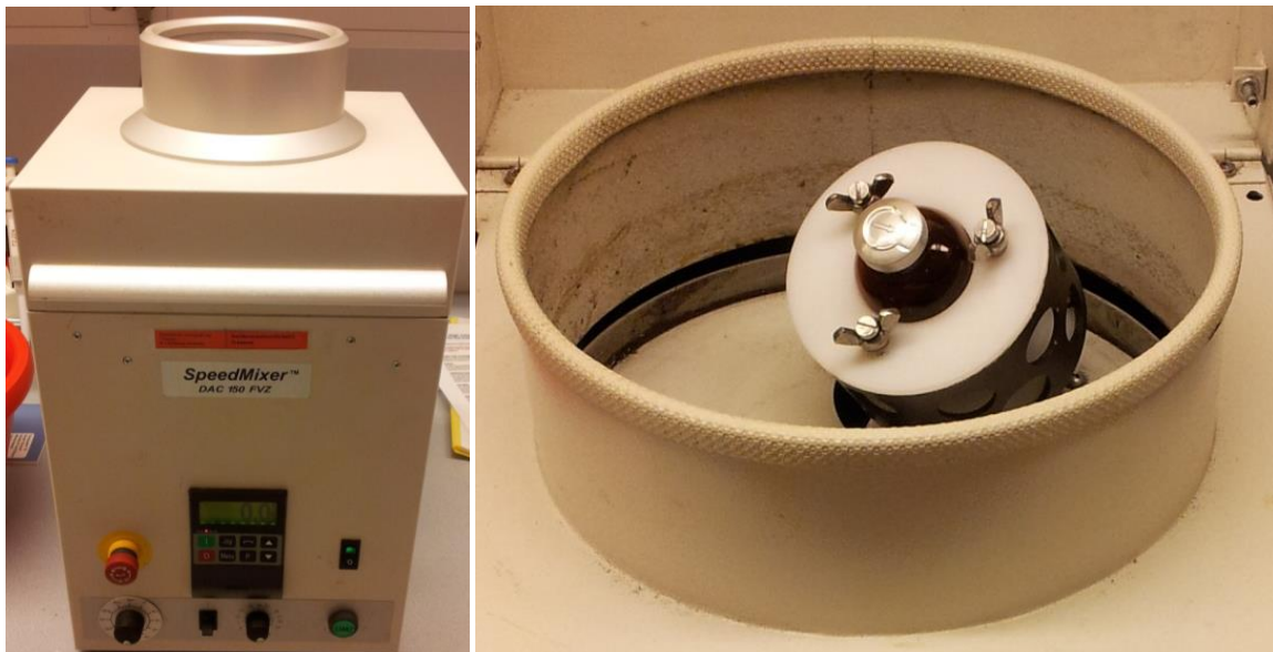
Figur 13. Venstre: DAC'en (SpeedMixer DAC 150 FVZ) som ble benyttet i denne studien. Høyre: Injeksjonsglass montert med egnet innsats i sentrifugen
