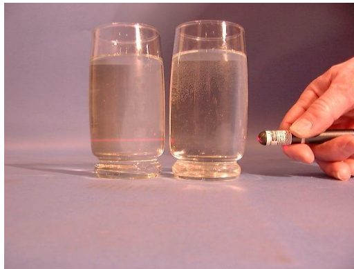
Figur 3: Illustrasjon av Tyndall-effekten: To tilsynelatende klare væsker bestråles med fokusert lys, her en laserpenn. Væsken til venstre inneholder sub-visuelle partikler, noe som påvises ved den røde linjen ( http://silver-lightning.com/tyndall/ )
