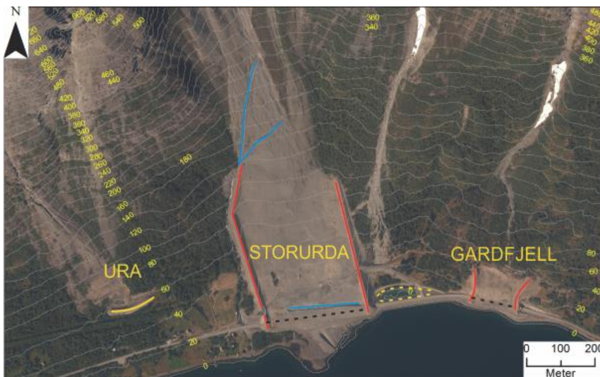
Figur 18: Skredsikring av Fv91 ved Kjosens i Lyngen. Fv91 er stiplest i sort gjennom skredoverbyggene ved Storurda og Gardfjell. Masseavlagringsbassenget er stiplest i gult, ledevoller er markert i rødt og dreneringsgrøfter i blått. Skredvullen ved Ura er merket i gult. Flyfoto fra 2011.
