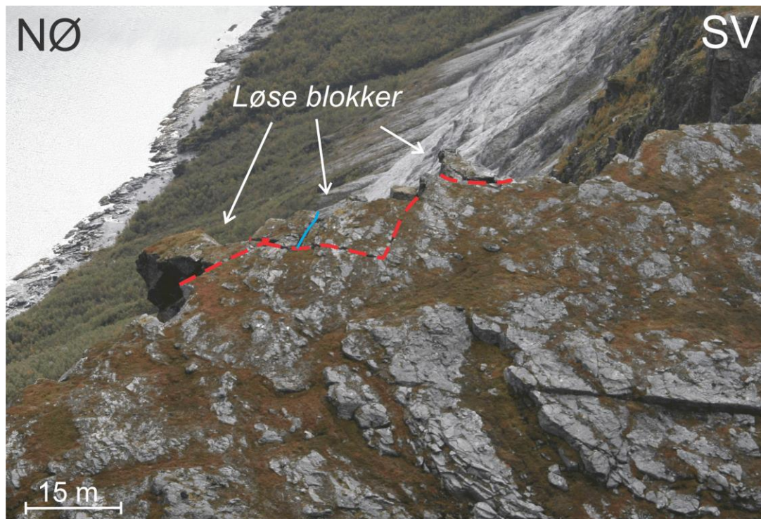
Figur 35. Helikopterfoto med tolking av sprekker(blå) og baksprekker(raud) på kanten av Brosmebakktuva.. Foto: I Henderson, 2006 (NGU), modifisert til oppgåva.
