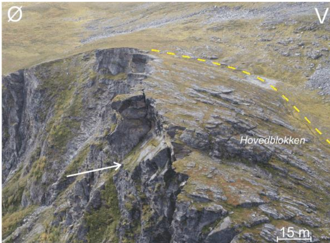
Figur 34. Helikopterfoto over Brosmbakktuva. Forseinkinga i terrenget ut til stupet kallast hovudblokka. Legg merke til blokkene på kanten av stupet og antatt glideplan (pil). Gul linje for avgrensning av ustabil område. Foto: I Henderson, 2006 (NGU), modifisert til oppgåva.
