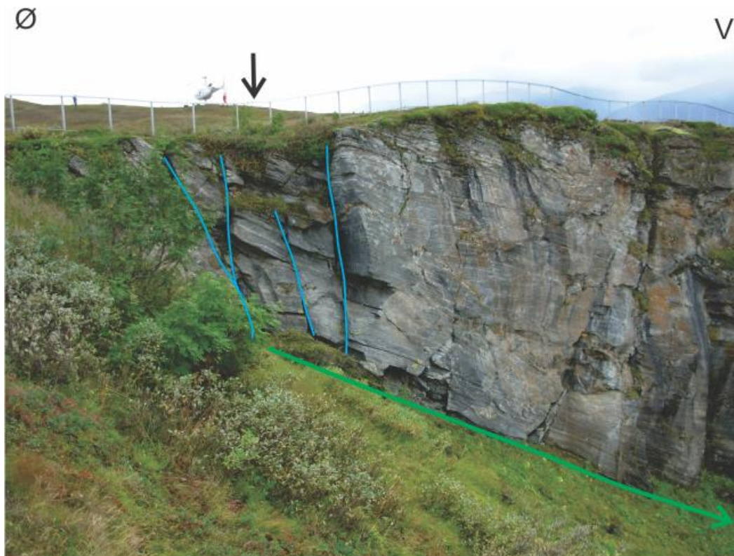
Figur 76. Struktur i bakkant av nordveggen på Storsteinen. Blått syner sprekkar, grønt indikerar foliasjonsparallelt glideplan og svart pil peiker mot antydning til forsenking i terrenget. Foto: A. Saintot, 2006 (NGU).
