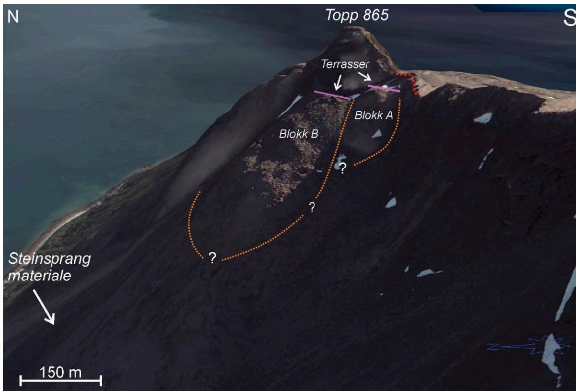
Figur 52. Tolkingar med baksprekk i rødt, antatte grenser for blokk A og B i oransje, og terrassar i rosa. Foto: Norgei3D.
