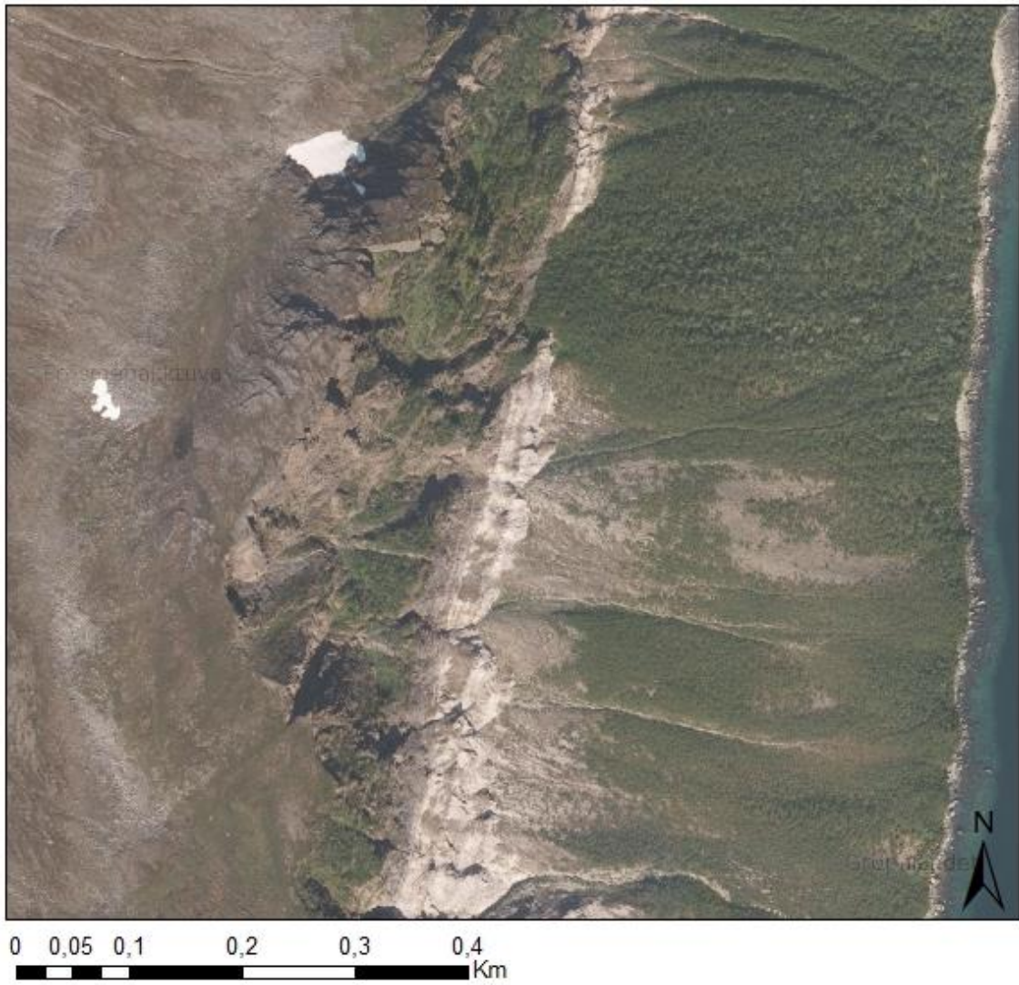
Figur 32. Flyfoto over Brosmebakktuva. Legg merke til renna/søkket som går mot nord ut av bilete, sprekkane på toppen av «hovudblokka», viftene og skredløp i avsetningane, og bergartsforskjellen nede i skråninga. Det kvite båndet er dolomitt. Foto: NorgeiBilder.
