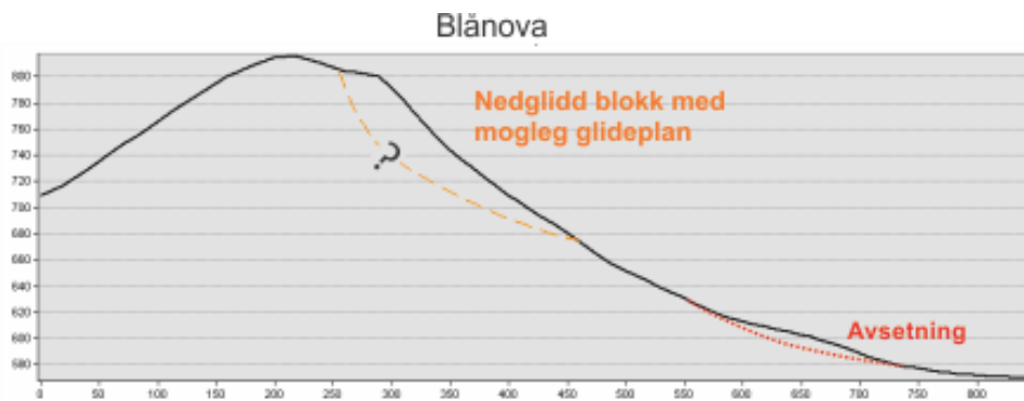
Figur 70: Høgdeprofil over Blånova med mogleg glideplan og avsetningar innteikna.
