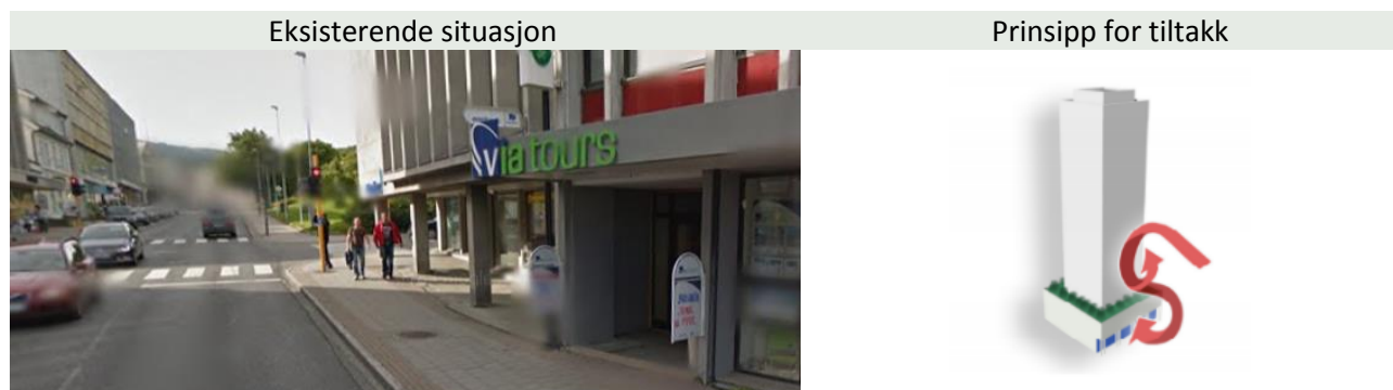
Figur 61. Prinsipp for løsning som reduserer nedslagsvind.
