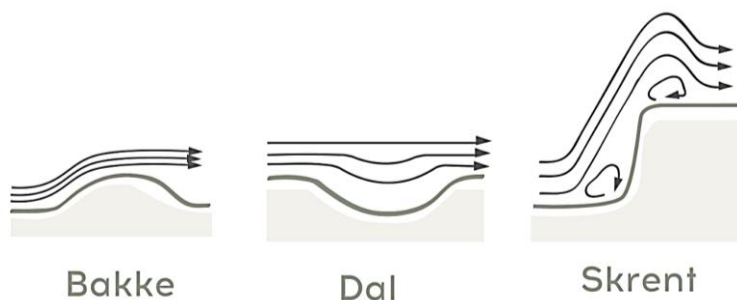
Figur 20. Vindstrømming i forskjellige terrengform (basert på Bjerg, 2012).
