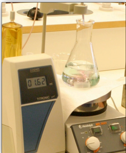
Figur 3-5: HCl titreres i fortynnet borsyreløsning til fargeomslag fra grønt til rosa.
