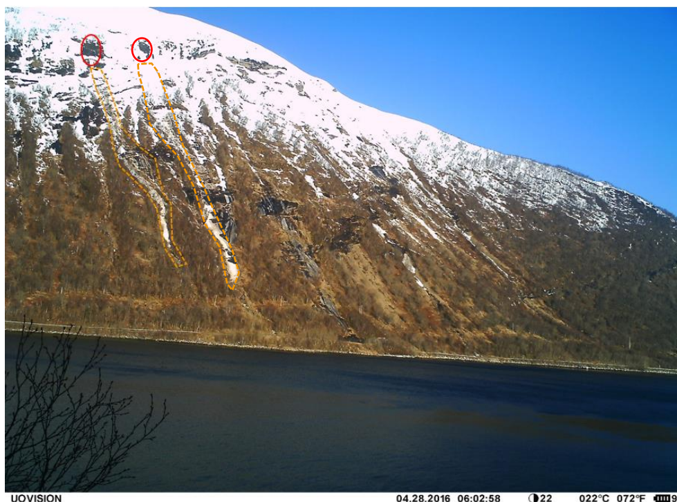
Figur 30. To av hendelsene som ble registrert på geofonene natt til 28. april 2016. Løsneområdene er indikert med rød sirkel, skredbanen og avsetningene er indikert med oransje stiplet linje. Skredet til høyre gikk i skredbane 3B og skredet til venstre gikk i skredbane 4A. Bildet er tatt med viltkameraet.
