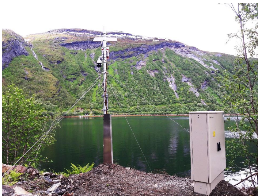
Figur 18. Dopplerradar fra Geopraevent i Sandneslia. Strømskap til høyre. Bildet er tatt av forfatteren under befaring i Sandneslia sommeren 2017.
