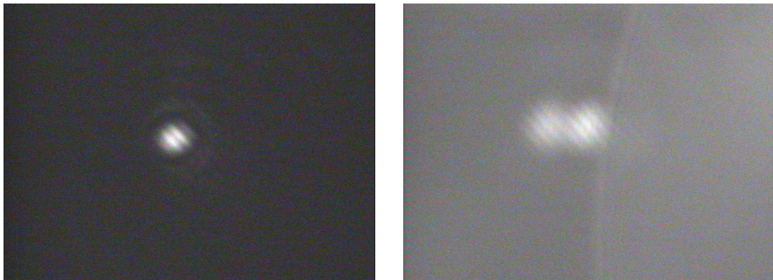
Figur 4.6-2: Til venstre: Fundamental modus til en 2\mu\text{m} bred bølgeleder. Til høyre: To høyere ordens modi til en 2\mu\text{m} bred bølgeleder.
