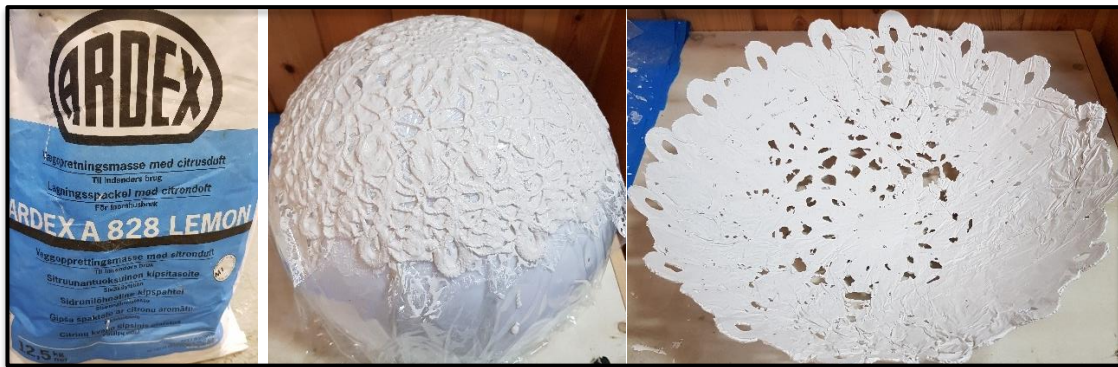
Figur 17: Forsøk med gips. Hvit duk med små og mellomstore maskehull, 42 cm i diameter.
