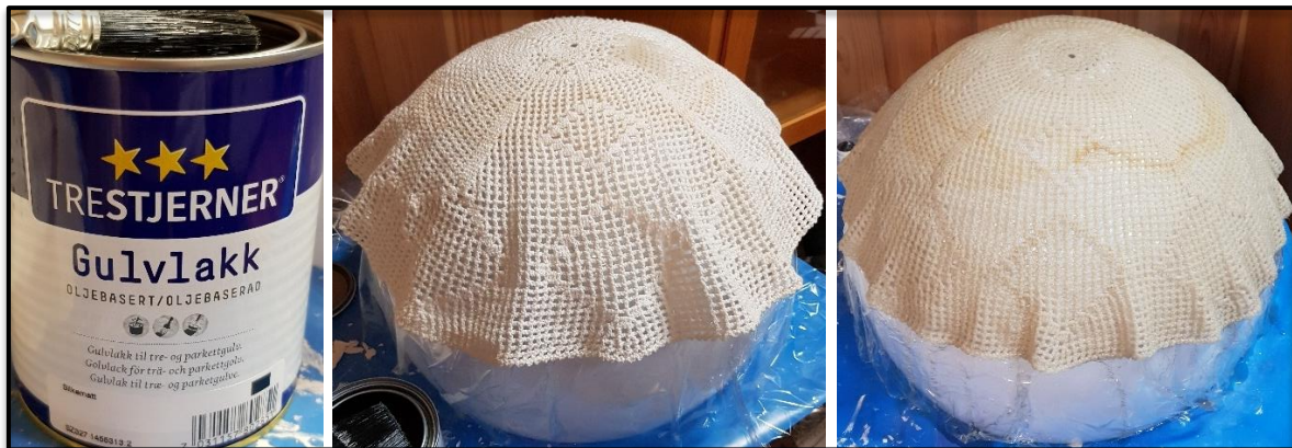
Figur 13: Forsøk med oljebasert lakk. Gulnet naturhvit duk med små maskehull, 53 cm i diameter.
