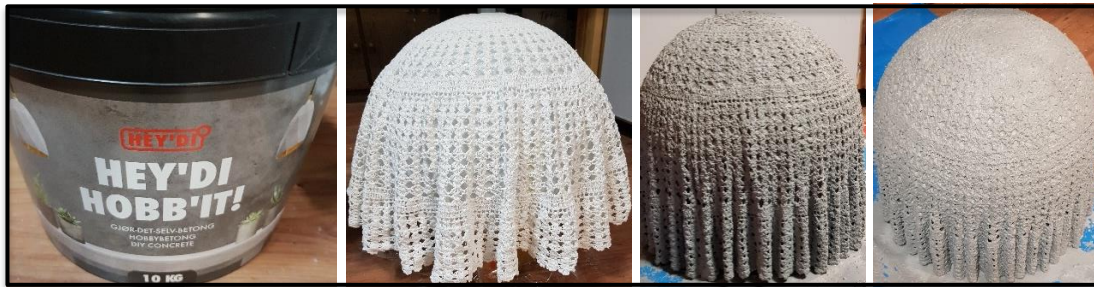
Figur 31: Forsøk med betong. Hvit duk med små og mellomstore maskehull, 101 cm i diameter.
