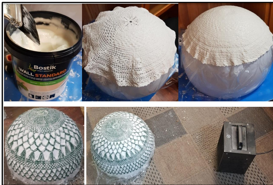
Figur 7: Forsøk med tapetlim. 1.forsøk: Hvit duk med små maskehull, 43 cm i diameter. 2.forsøk: Grønn duk med små, mellomstore og store maskehull, 59 cm i diameter.
