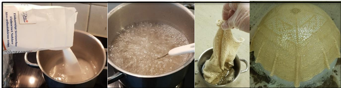
Figur 19: Forsøk med sukkerlake. Naturhvit duk med små maskehull, 70 cm i diameter.
