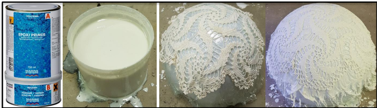
Figur 23: Forsøk med epoxy. Hvit duk med små, mellomstore og store maskehull, 56 cm i diameter.
