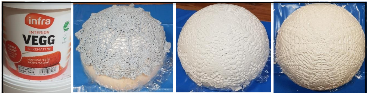
Figur 33: Forsøk med akrylmaling. Blå duk med små, mellomstore og store maskehull, 48 cm i diameter.
