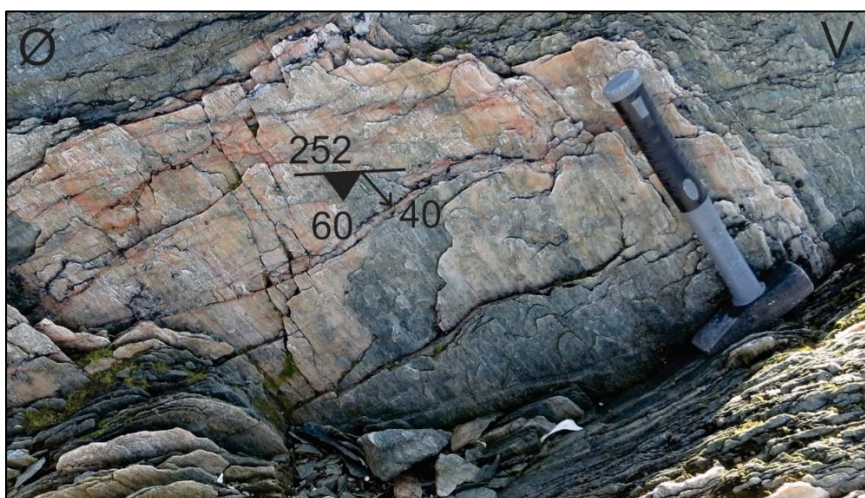
Figur 44. Strekningslineasjoner observert i foliasjonsplanene. Foliasjonsmåling (strøk- og falltegn) og strekningslineasjon (pil) er tegnet inn riktig i forhold til målingen i foliasjonsplanet.
