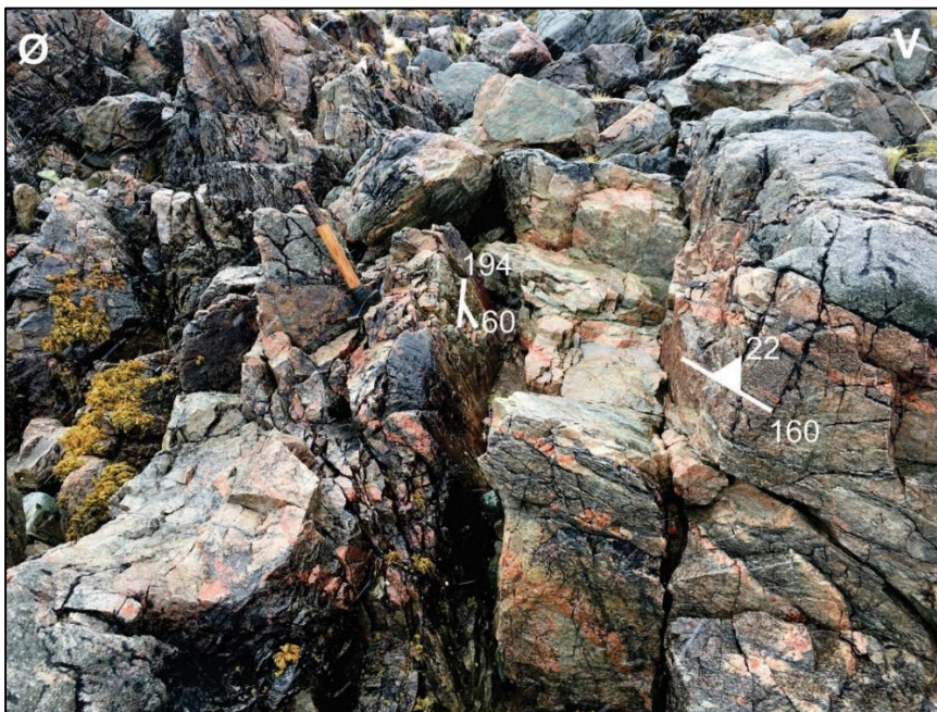
Figur 43. Sprø bruddsone til venstre i bildet, og foliert grunnfjellsbergart til høyre i bildet. Glideplanet er tegnet inn med strøk og fall, og foliasjonen til bergartene vises i form av foliasjonstegnet. I glideplanet er det også utfelt hematitt.
