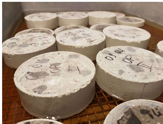
Figur 20: Betongprøver i kapillær-vannoppsug testing
