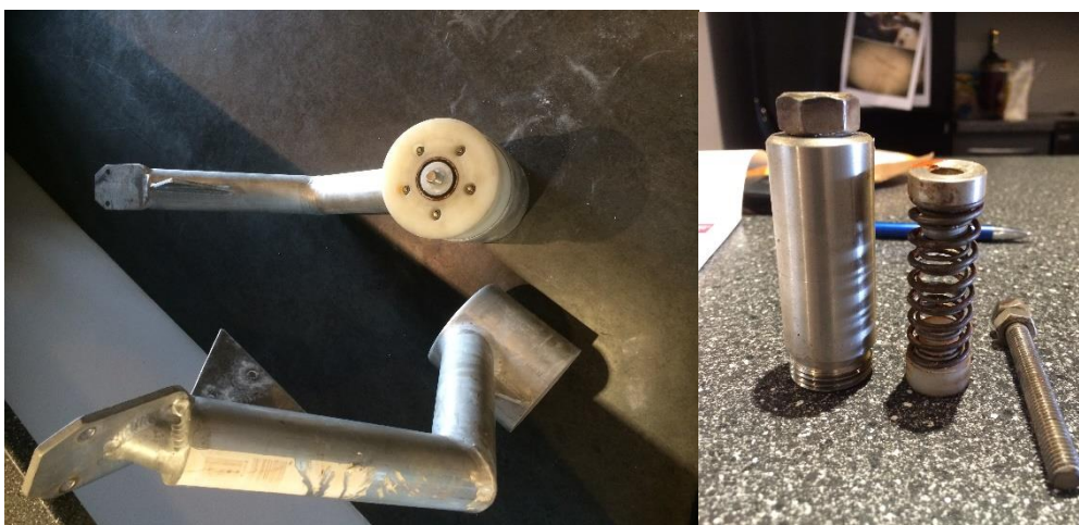
Figur 27: Gjennomføring er kløyvd og en kan se selve bremseakslingen (venstre). Figuren til høyre viser komponentene i bremsen, (Sylinder, fjær og bolt for å justere bremsekraft) (Foto: Nordheim, 2014).
