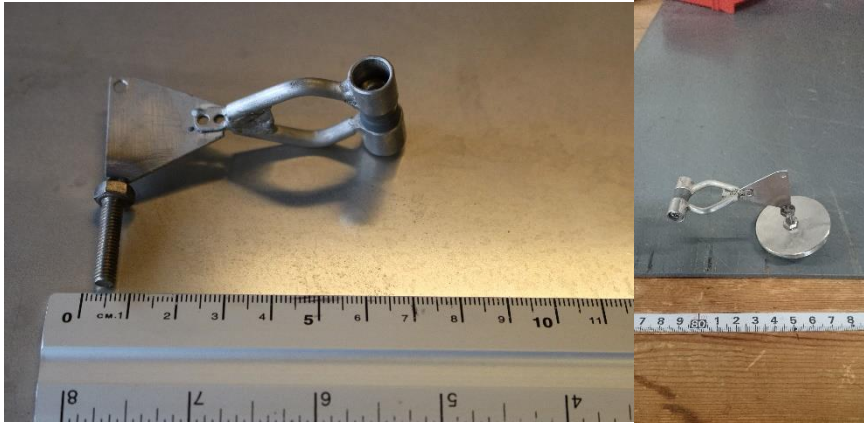
Figur 37: 1:20 modell av rigg. Bildet til høyre viser tillagt vekt monterert med hensikt å holde riggen vannrett i vannet. (Foto: Nordheim 2014.)
