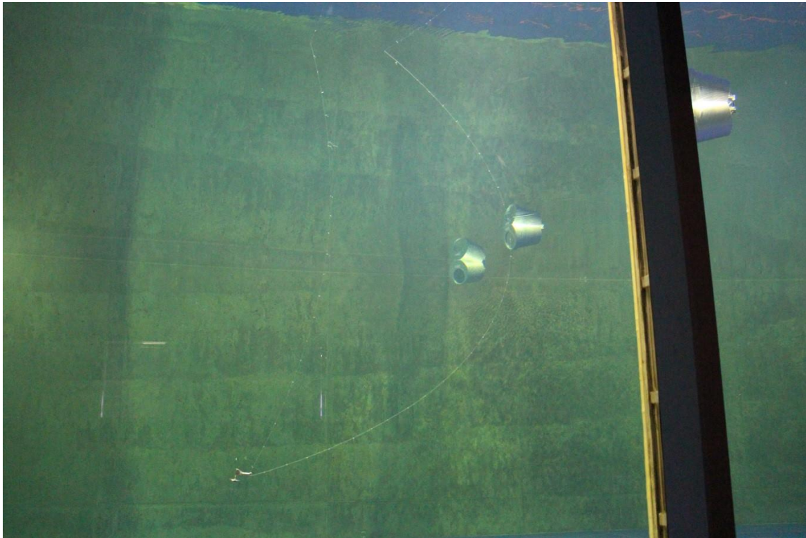
Figur 44: Dybde/lengdeforholdet er 1:3 mens farten er på 1 knop. Bukten på bakparten bak gjennomføringen er relativt smal, og dorgen virker stram (Foto: Nordheim, 2014).
