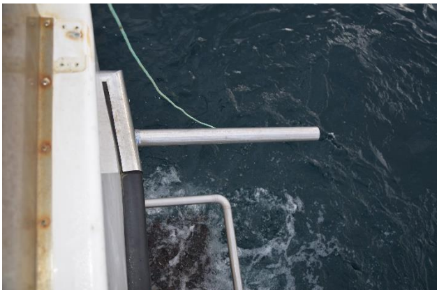
Figur 18: Gjennomføringsrøret stakk ut akter. Tauet som stikker ut av røret på bildet ble brukt under setting og opptak av riggen (Foto: Nordheim, 2013).
