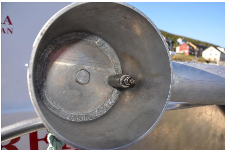
Figur 30: Skrue for å justere motstand på brems (Foto: Nordheim, 2013).
