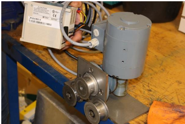
Figur 40: Elektrisk motor med frekvensomformer ble brukt for å drive dorgen under forsøkene i Hirtshals (Foto: Nordheim, 2014).
