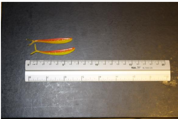
Figur 35: Gummifisk som ble benyttet for å simulere ordentlig fisk og dets effekter på dorgesystemet. Hver fisk tilsvarte 10 kg i virkelig vekt (Foto: Nordheim, 2014).
