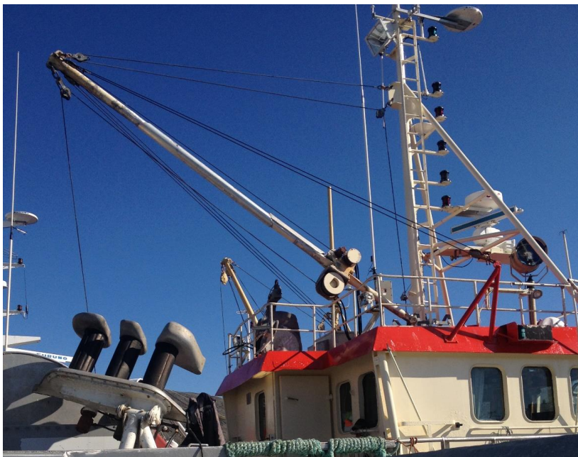
Figur 42: Dersom bommen er svingbar, kan hele riggen løftes opp fra dekket og svinges frem til styrbord for så å sette den ut (Foto: Nordheim, 2014).
