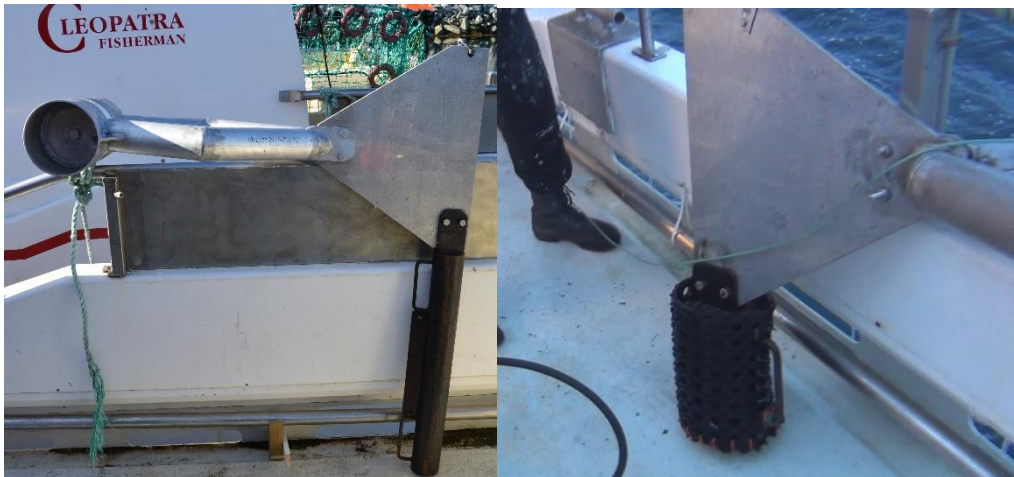
Figur 33: Lodd av lang type (venstre) og kort type (høyre), begge montert på rigg (Foto: Nordheim 2014).
