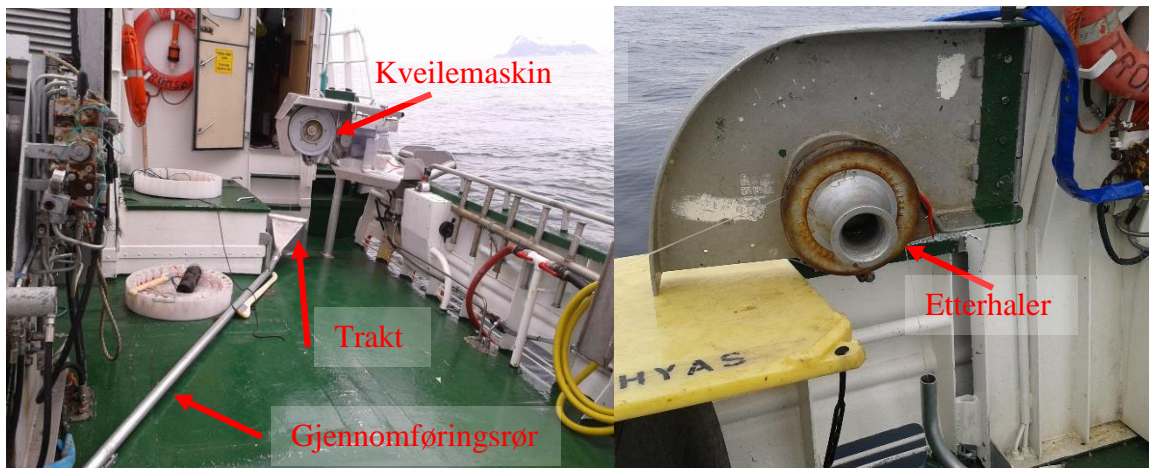
Figur 14: Gjennomføringsrøret begynner ved en firkanttrakt med runde kanter, går så diagonalt over til babord hekk (t.v.). Enden i røret er bendet opp slik at dorgen ledes rett inn til spillet på etterhaler (t.h.) (Foto: Nordheim, 2013).
