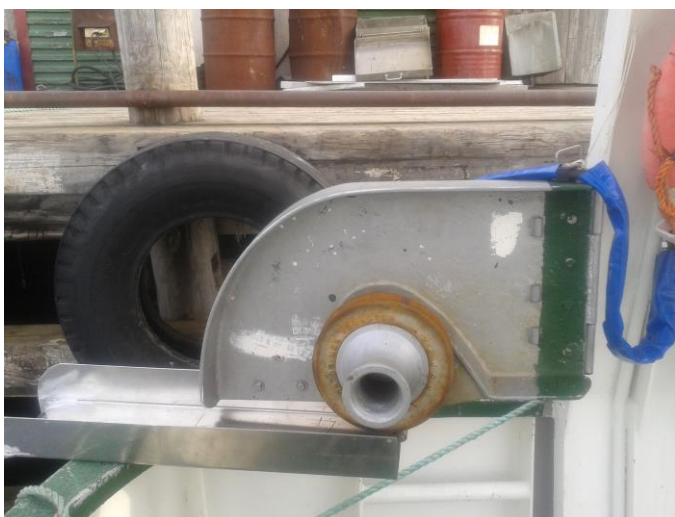
Figur 12: Etterhaler montert på hekken. Etterhaleren besto av et spill med tilhørende nokk og ledeplate. På bildet er også en renne montert for å hjelpe anglene ut i havet problemfritt (Foto: Nordheim, 2013).
