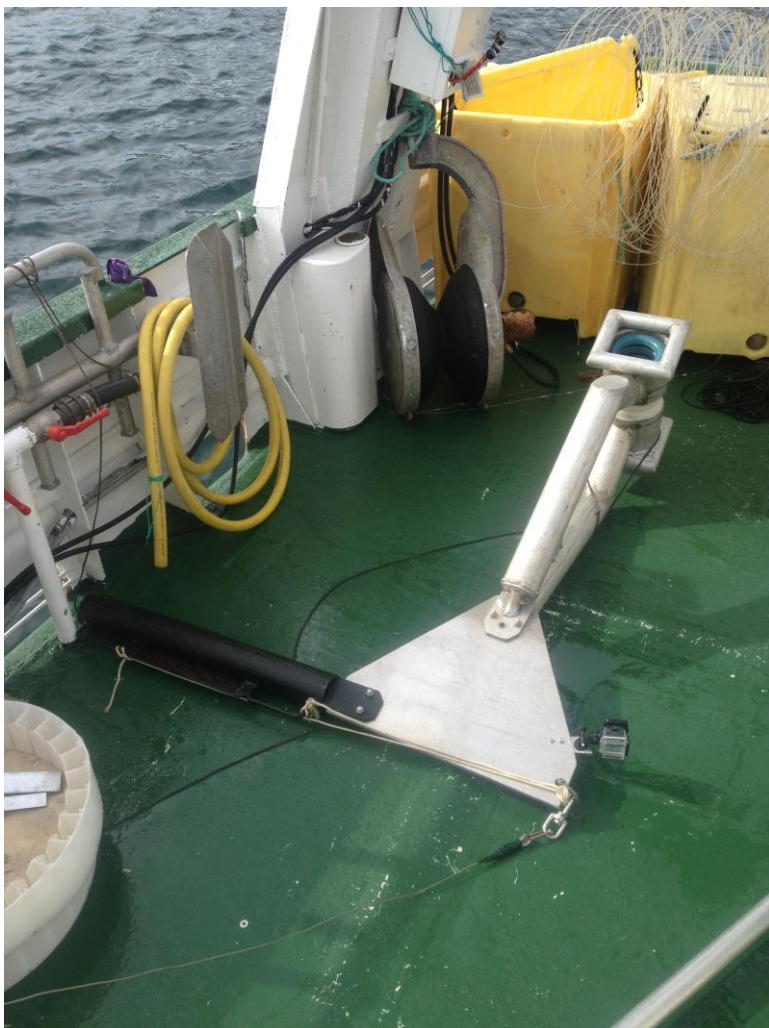
Figur 15: Gjennomføring, wire og lodd samt GoPro kamera montert på base (Foto: Vollstad, 2013).
