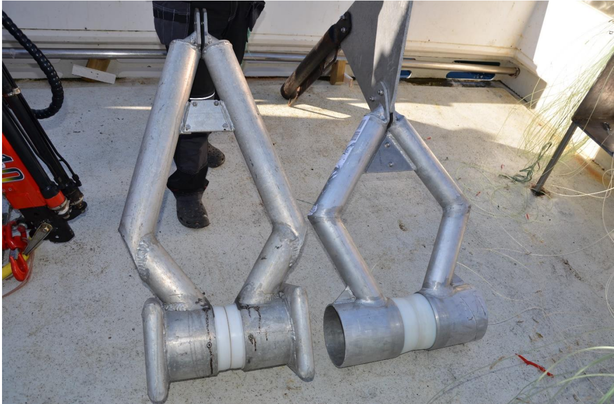
Figur 29: Gjennomføring 1 (venstre) og gjennomføring 2 med base og lodd montert (høyre) (Foto: Nordheim 2013)
