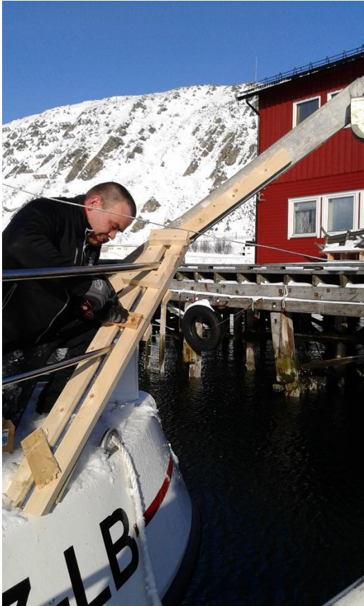
Figur 16: Skipper Jonny Pedersen monterer runddorgens utligger på "Ørntind" (Foto: Nordheim, 2014).
