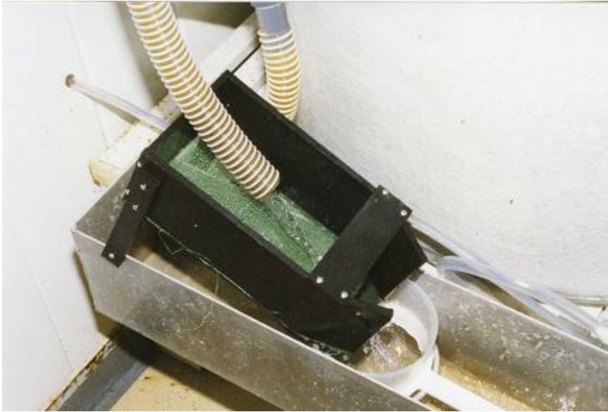
Bilde 2.2 Fôroppsamlaren som vart brukt ved fôrinntaksmålingane. Overskotsfôr blir spylt ut frå karet med avløpsvatnet, og blir liggjande i fôroppsamlaren eller i dørslaget.
