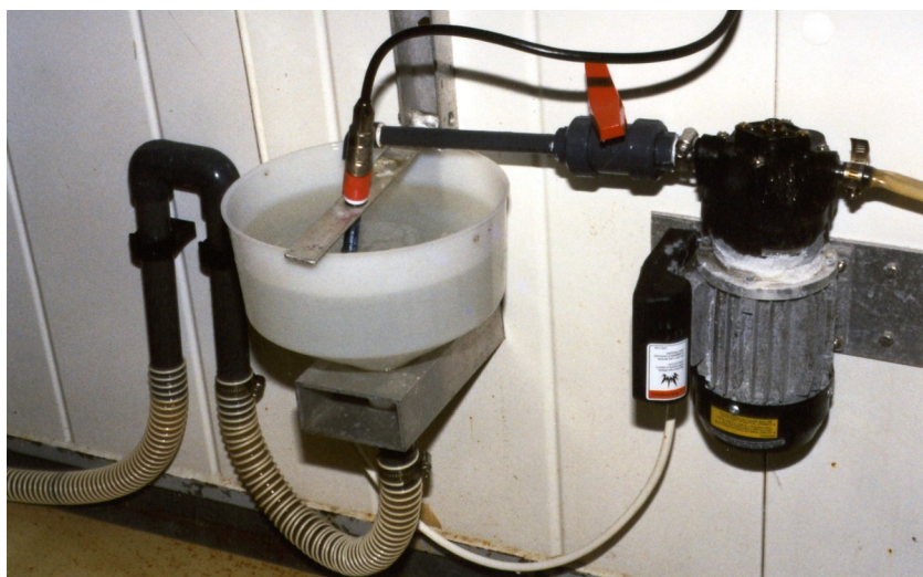
Bilde 2.1 Haldecella med oksygensensoren. Pumpa til høgre forsyner haldecella i midten med vatn frå avløpet til forsøkskara. Avløpsmunken til venstre regulerer og opprettheld vassnivået i haldecella.
