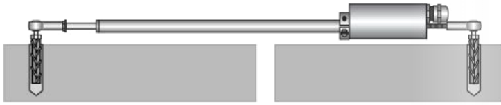
Figur 35: Illustrasjon av hvordan en VW Crackmeter er montert på hver side av en sprekk. Figur hentet fra Slope Indicator Company (2003).
