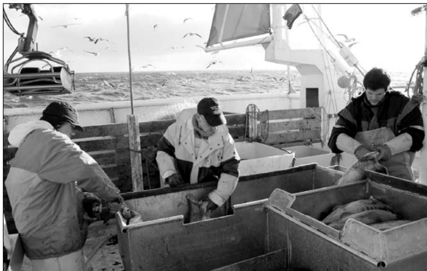
Figur 3. Når bingen i høyre billedkant er full, slippes fisken i rommet. I venstre billedkant vises en annen styringsanordning, garngreieren, som erstatter to mann under haling. Foto: Jahn Petter Johnsen
