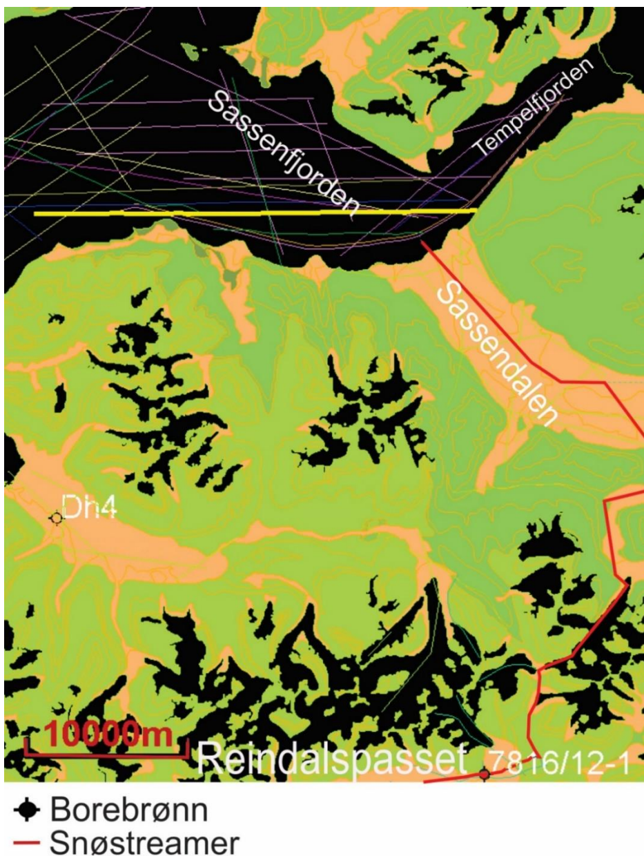
Figur 1.11: Viser de seismiske linjene (røde) som knytter seismikken fra brønnlokasjonen i Reindalspasset (brønn 7816/12-1) og seismikken i fjordene. Linjene i fjordene representerer marin seismikk og har flere farger. Hver farge av disse representerer forskjellige seismiske sett som er samlet inn på forskjellige tidspunkt. Den røde linja representerer seismikk utført med snøstreamer. Dh4 er en brønn knyttet til et CO2-prosjekt i Longyearbyen.
