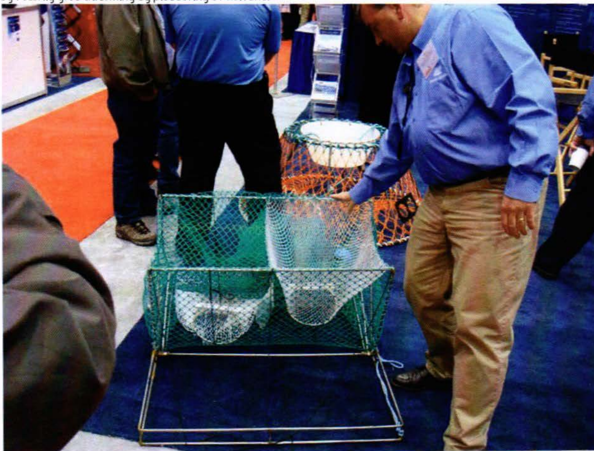
Bilde 3 Den canadiske teina er sammenleggbar. Her demonstrerer Phil Walsh prinsippet på en nedskalert (1:2) modell (Foto: Lasse Rindahl).
