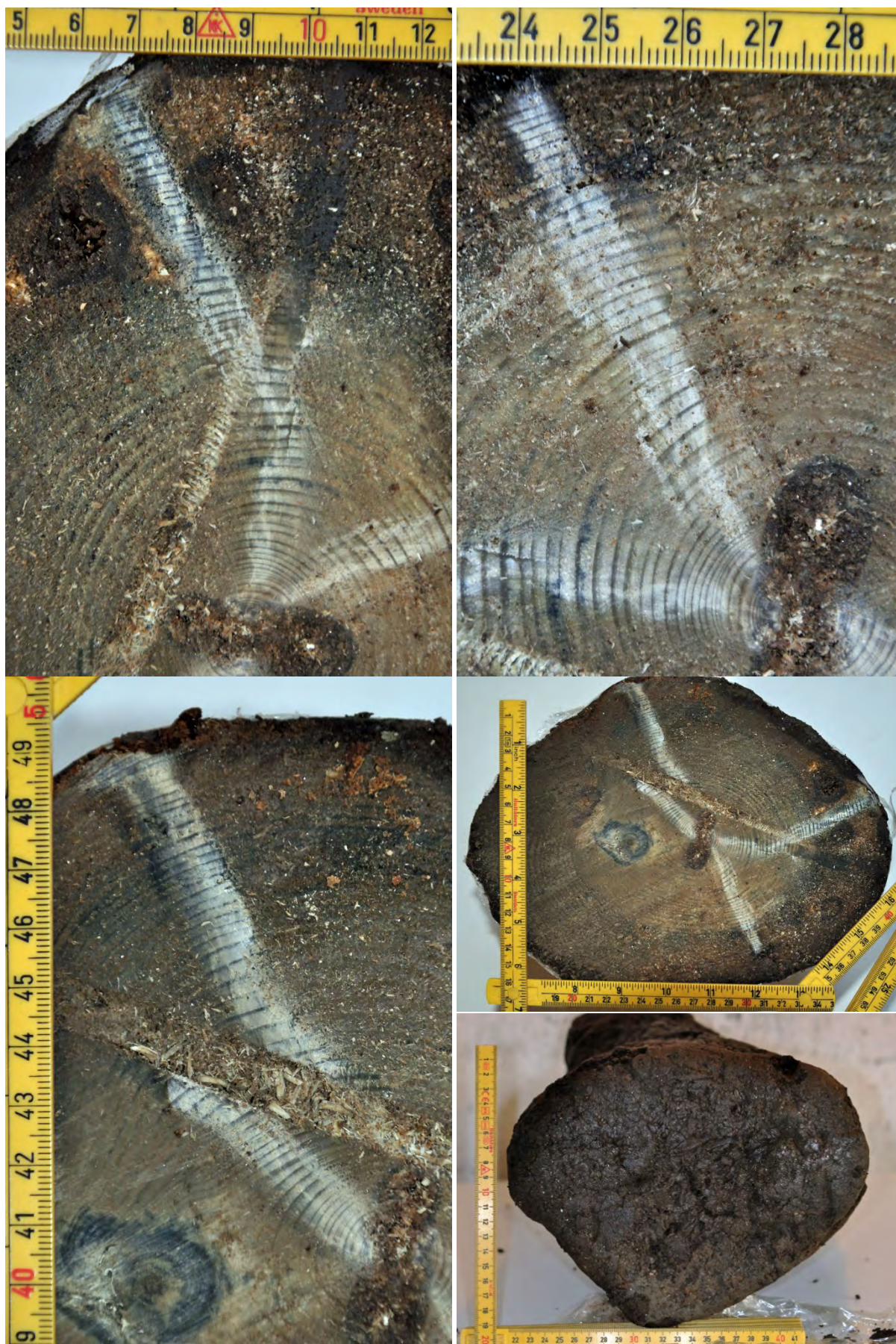
Figur 6: Nærbilder av de oppmålte radiene på snittet. Nederst til høyre: Gammel sag- eller hoggflate.
