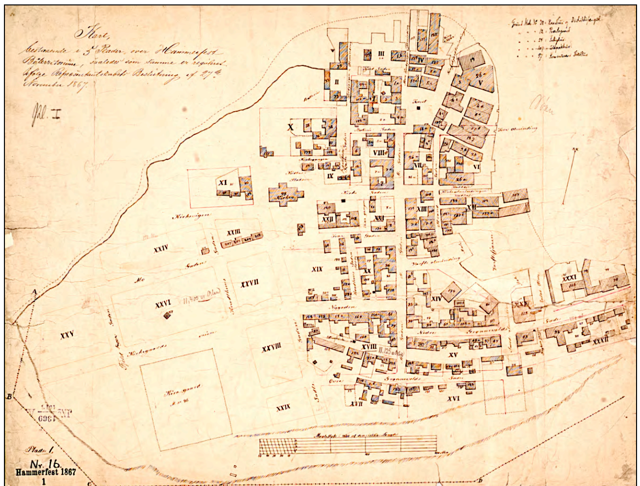
5 A. Reguleringskart over Hammerfest fra 1867. Dette er en av fem plansjer som ble laget i forbindelse med arbeidet med reguleringsplanen som ble approbert i 1872. Plansje 2 viser området øst for dette frem til Storelva, plansje 3 viser et område innerst i bukta fra Storelva. Plansje 4 viser nordsiden av bukta, og plansje 5 er selve Fugleneset. RA, kartsamlingen, Reg. 16.
