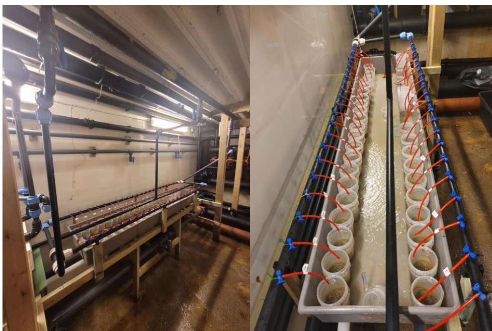
Figur 7. Oversikt over testtriggen med vannforsyning inn fra sidene og på midten (svart), inkludert separat justeringsventil for vanntrykk (blå), til hver enkelt inkubator.
