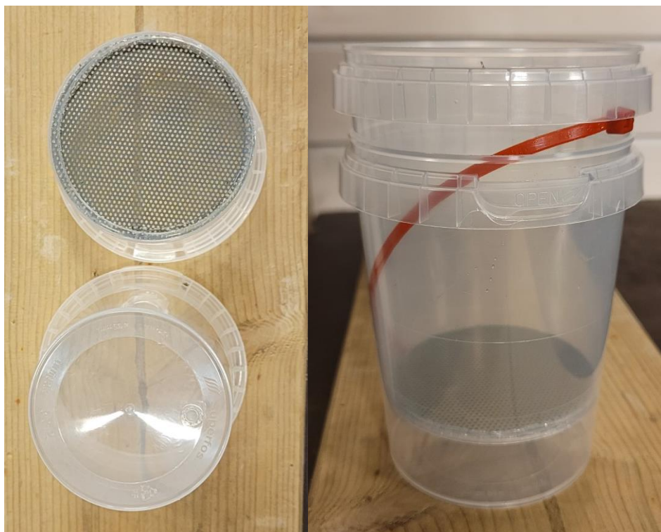
Figur 6. Oppsettet av inkubatorene. Inkubatoren var designet slik at rognen ble oppbevart på den grå plastristen under inkubasjon og vannet beveget seg over rognen for så å renne ut av toppen på det nederste plastbegeret, ved den røde stripsen.
