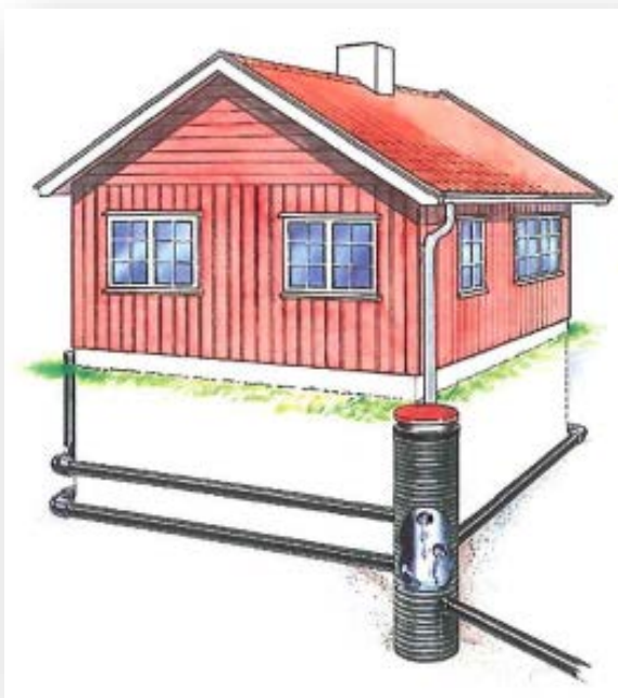
Figur 73 - Takrennedløp og husdrenering
