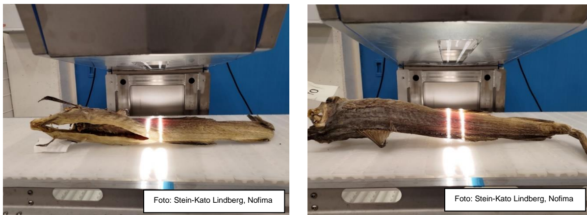
Figur 7 Tørrfisk på transportbånd for måling av egenskaper og kvalitetsfeil ved bruk av hyperspektral avbildning. Fisken belyses med intens lyskilde (de parallelle lysstripene) og sensoren registrerer kontinuerlig lys fra overflate og muskel i området mellom lysstripene. På dette viset blir tørrfisk/prøven scannet fra nakke til spord. Som illustrert i disse bildene, er tørrfisk et utfordrende prøvemateriale ved at den har varierende utforming og geometri. Dette gjør det utfordrende å etablere et standardisert område for måling på fisken.
