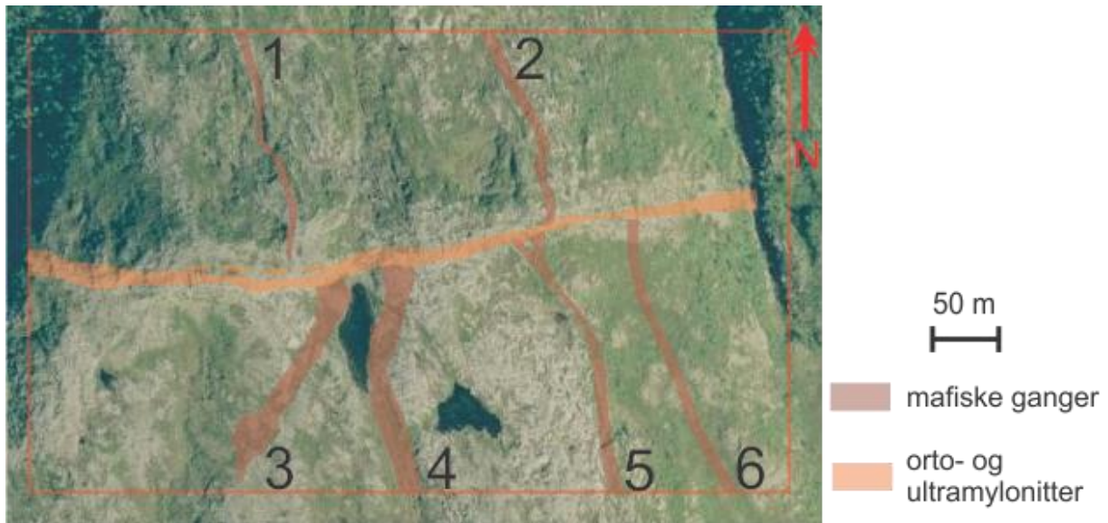
Figur 3. 20 Mafiske gangsvermer som er tilnærmet foliasjonsparallele til de tonalittiske gneisene og som er kuttet av Lakselvhøgda skjærsone. Merk avbøyningen av gang 1-2 og 4-6 inn mot skjærsonen som indikerer dekstral bevegelse i Lakselvhøgda skjærsone.
