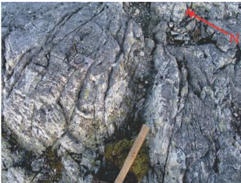
Figur 3. 37. Foto og stereoplott av sekundære sprekker i sone 2 stryker N-S til NØ-SV og VSV-ØNØ til Ø-V. n=29.
