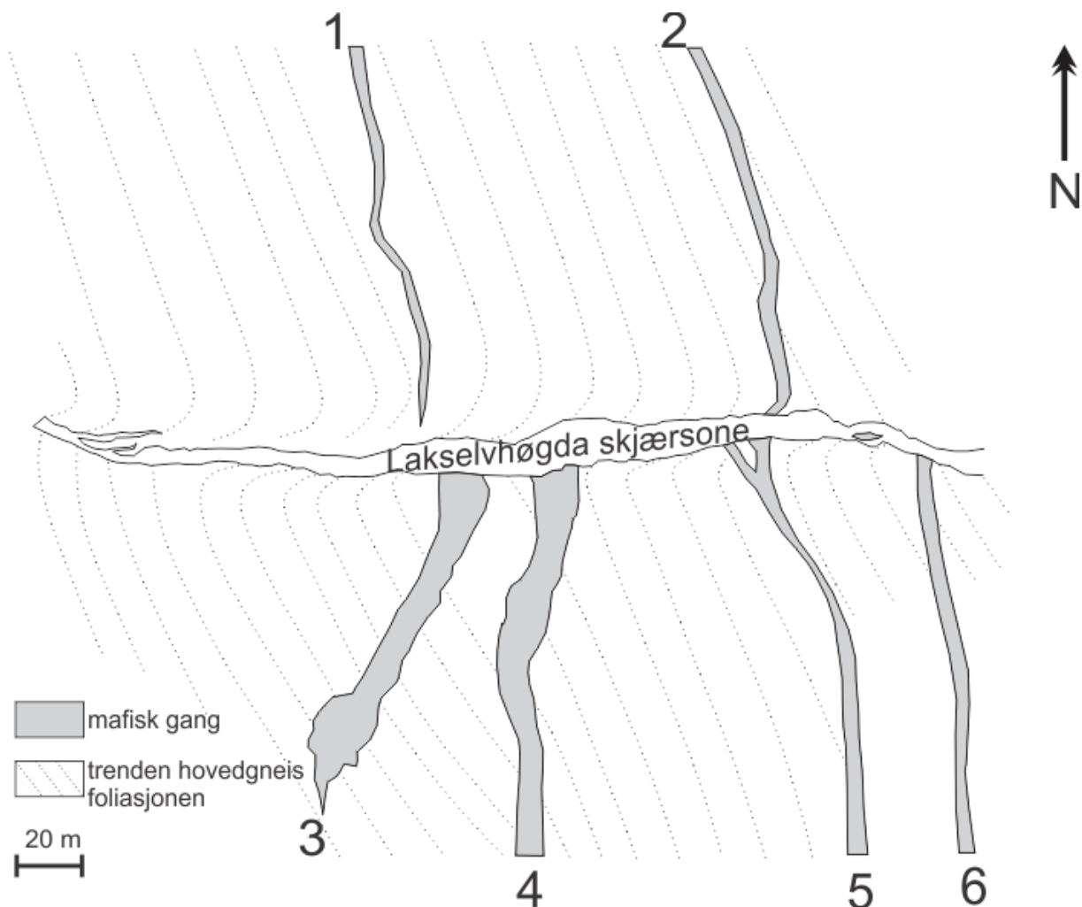
Figur 2. 2 De mafiske gangsvermene i Lakselvhogda skjærsone er tilnærmet parallelle til foliasjonen i de tonalittiske gneisene. Merk gang 2-6 som er kuttet av skjærsonen.
