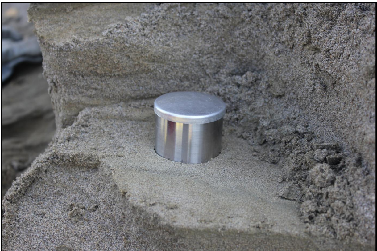
Fig. 3-2 Porøsitering før prøvetaking av 100 \text{ cm}^3 sediment. Den hule ringen er plassert på en lagflate gravd frem i toppen av den enheten som skal prøvetas. Ved å trykke ringen forsiktig ned i sedimentet, er det mulig å ta ut eksakt like store prøver.
